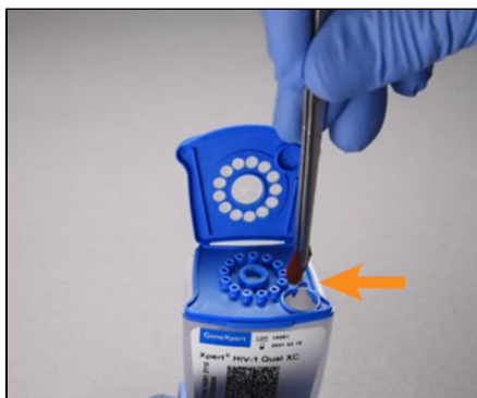
Рисунок 5. Введение СКК в камеру для образца
