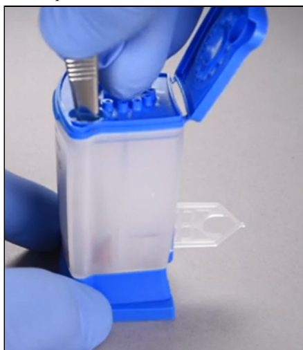
Рисунок 6. Образец СКК сложен на дне камеры для образца
