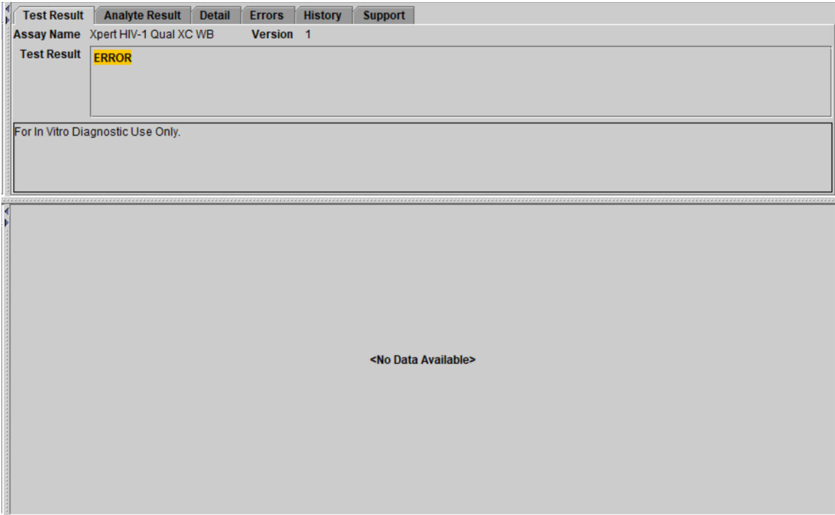
Figura 13. Error tal como se muestra en el GeneXpert Dx System y el GeneXpert Infinity System
