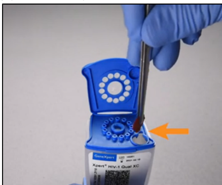
Εικόνα 5. Εισαγωγή της DBS στον θάλαμο δείγματος
