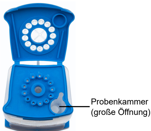
Abbildung 5. Xpert Xpress CoV-2/Flu/RSV plus -Kartusche (Draufsicht)
