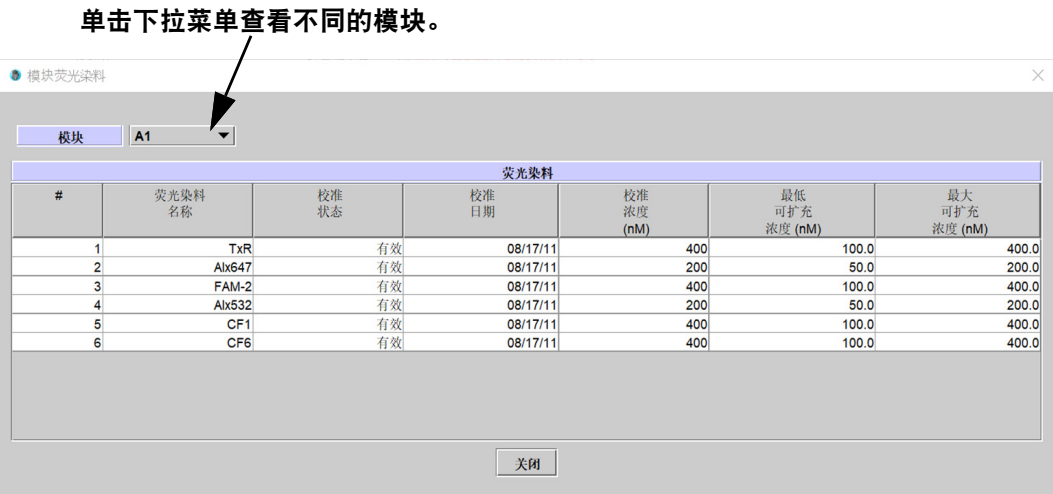
图 9-32. 显示 6 色模块的模块荧光染料
