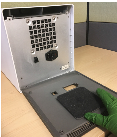
图 9-16. 更换较老款 GX-IV 内的防尘泡沫
