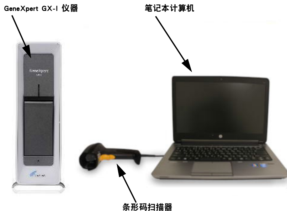
图 1-2. GeneXpert GX-I 硬件组件（以笔记本电脑示例）
