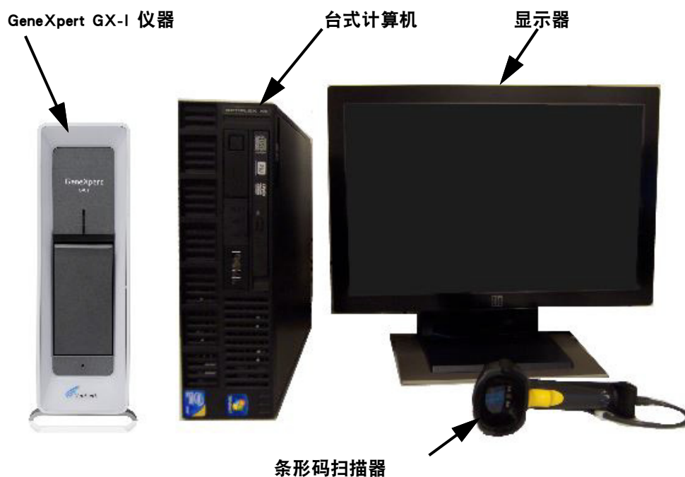
图 1-3. GeneXpert GX-I 硬件组件（以台式计算机示例）
