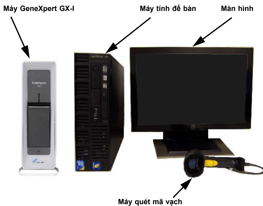
Hình 1-3. Các thành phần phần cứng của GeneXpert GX-I (Minh họa với máy tính để bàn)
