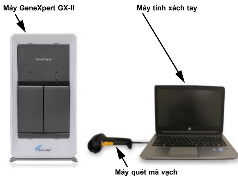
Hình 1-4. Các thành phần phần cứng của GeneXpert GX-II (Minh họa với máy tính xách tay)
