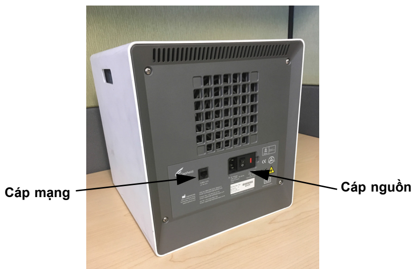
Hình 9-13. Các vị trí cáp nguồn và cáp mạng trên GX-IV cũ
