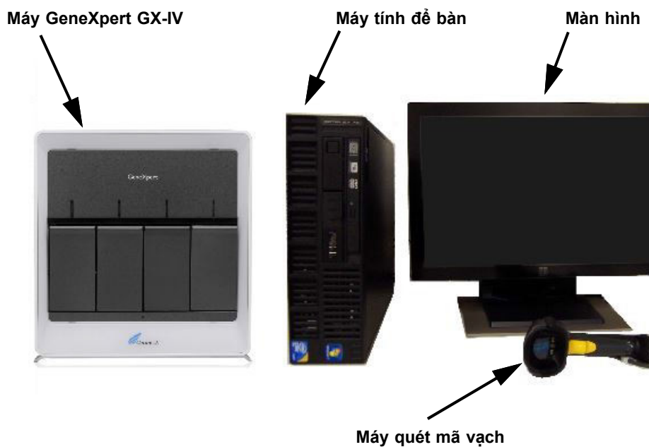
Hình 1-7. Các thành phần phần cứng của GeneXpert GX-IV (Minh họa với máy tính để bàn)
