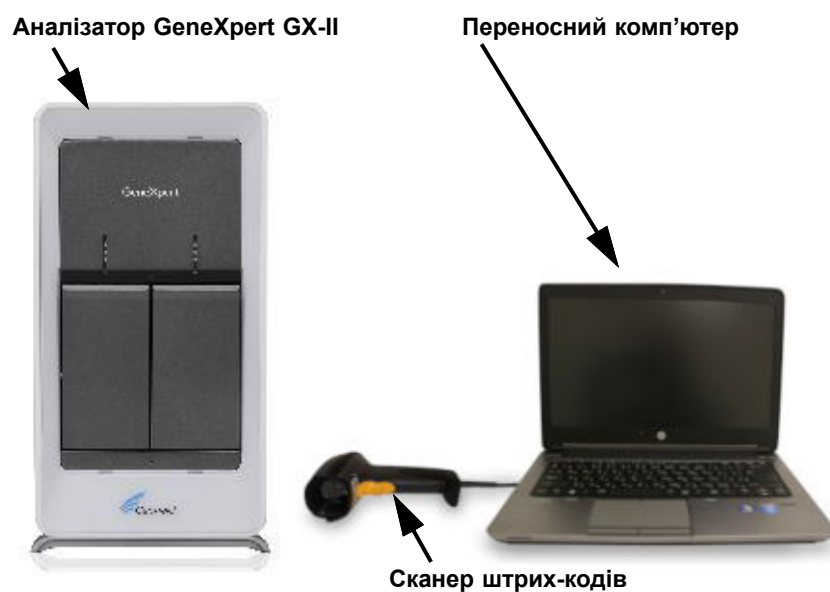
Малюнок 1-4. Апаратні компоненти GeneXpert GX-II (представлені разом з переносним комп'ютером)
