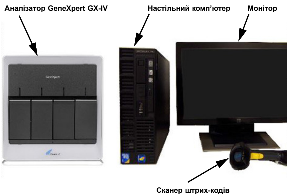
Малюнок 1-7. Апаратні компоненти GeneXpert GX-IV (представлені разом з настільним комп'ютером)
