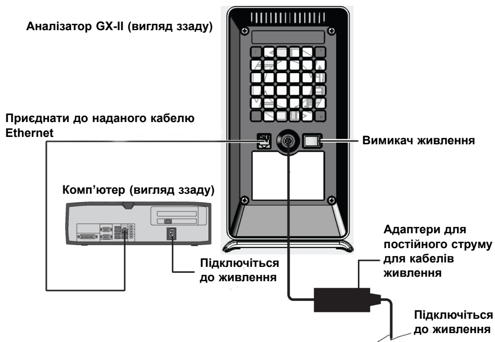
Малюнок 2-2. Підключення аналізатору GX-II до настільного комп'ютера
