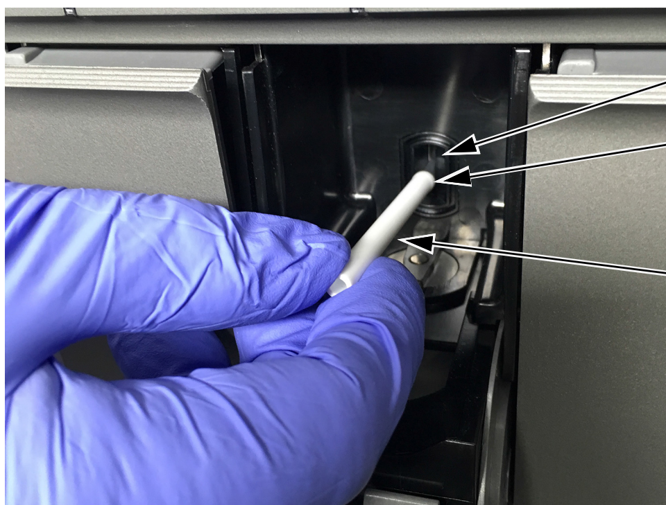
Малюнок 9-7. Введення щітки для чищення в щілину I-CORE
