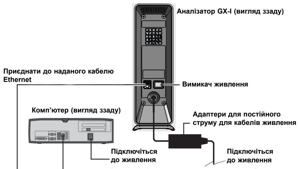
Малюнок 2-1. Підключення аналізатору GX-I до настільного комп'ютера
