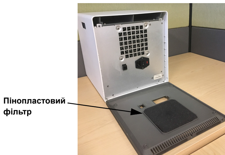
Рисунок 9-15. Пінопластовий фільтр у старій моделі GX-IV
