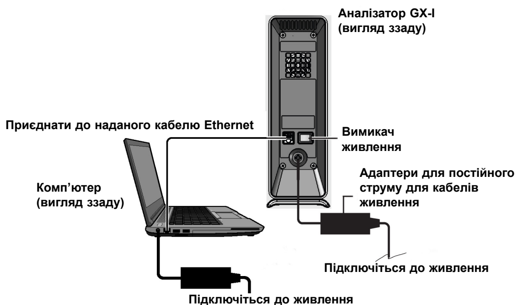
Малюнок 2-5. Підключення аналізатору GX-I до переносного комп'ютера
