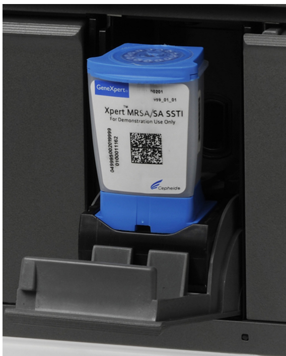
Малюнок 5-33. Картридж GeneXpert, розташований в найнижчій точці підлоги модуля
