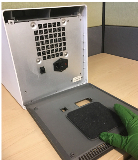
Рисунок 9-16. Заміна пінопластового фільтра в старій моделі GX-IV
