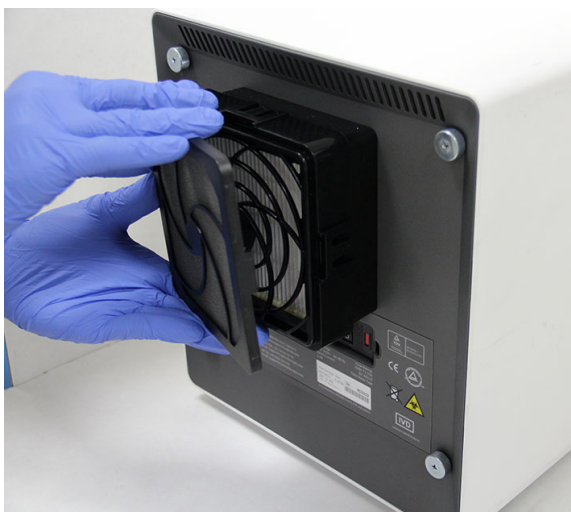
Малюнок 9-25. Видалення утримувача префільтра
