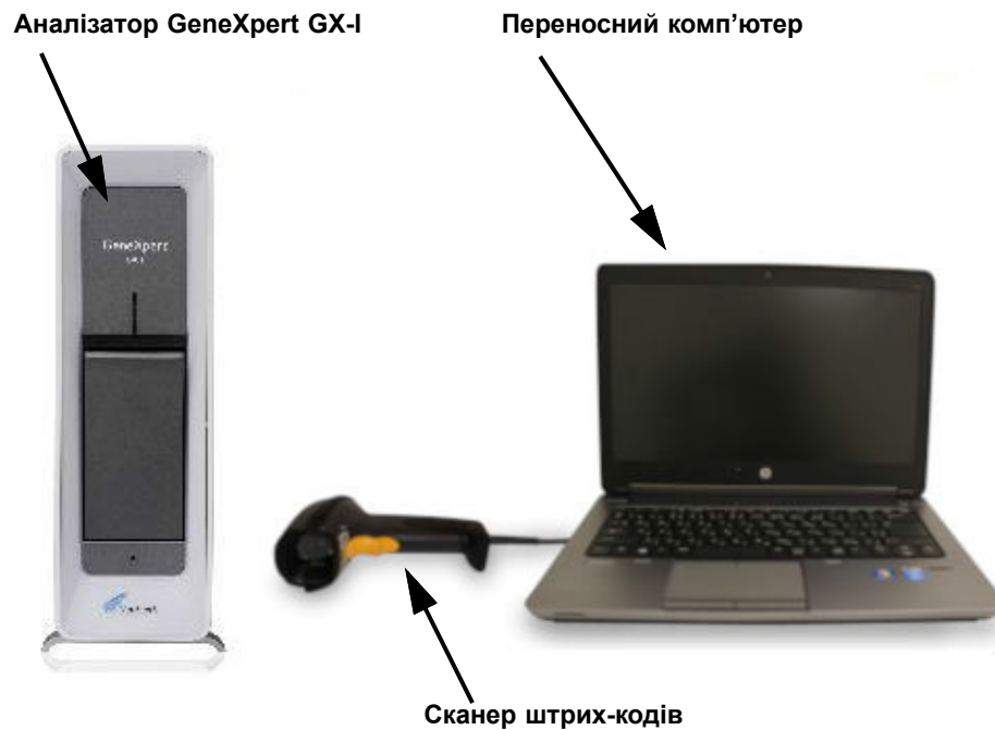
Малюнок 1-2. Апаратні компоненти GeneXpert GX-I (представлені разом з переносним комп'ютером)
