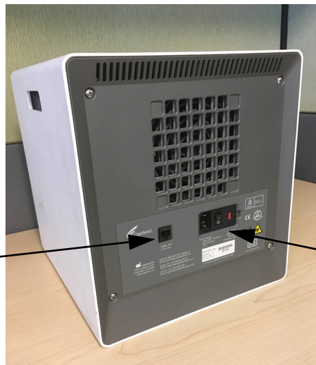
Рисунок 9-13. Розташування мережевого кабелю та кабелю живлення на старих моделях GX-IV
