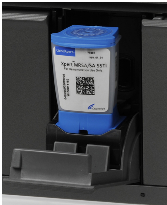
Figur 5-33. GeneXpert Kassett, placerad vid slutet av botten på modulnischen
