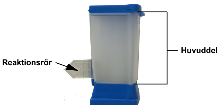
Figur 5-31. Kassetten som visar huvuddel och reaktionsrör
