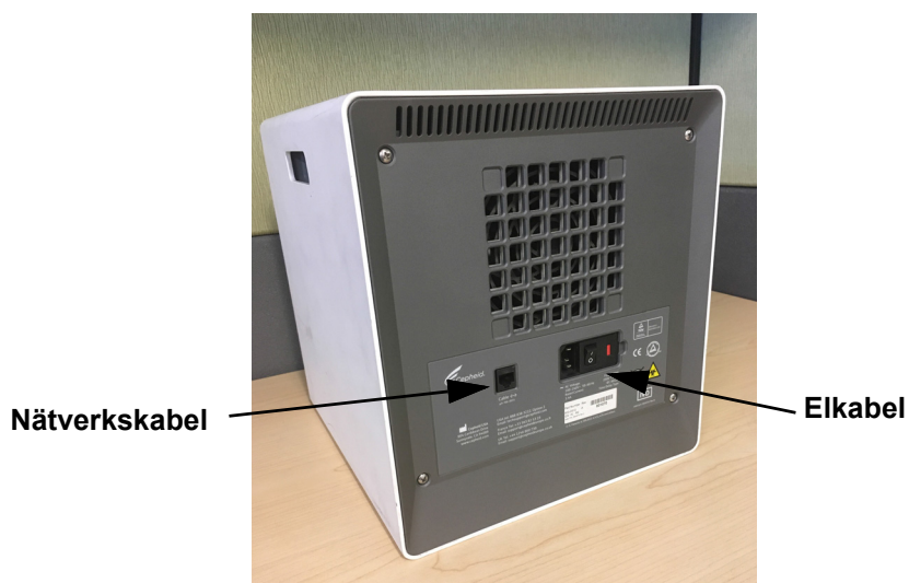
Figur 9-13. Platser för nätverkskabel och elkabeluttag på äldre GX-IV
