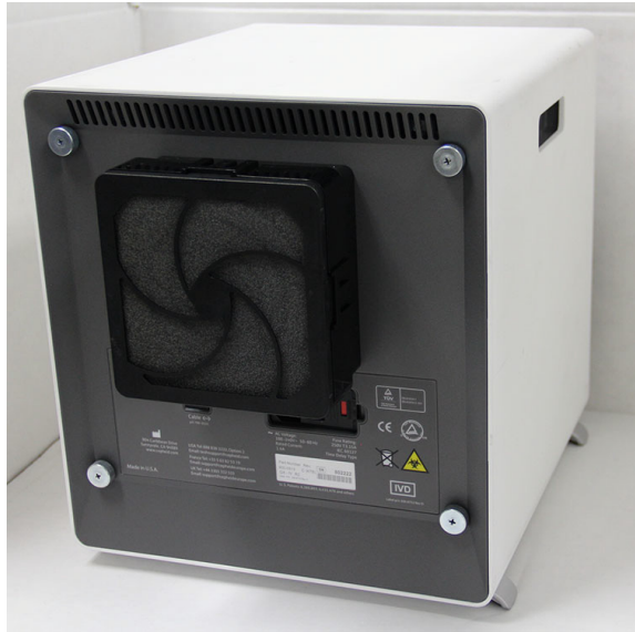
Figur 9-24. GX-IV-instrumentet placerat för åtkomst till filter
