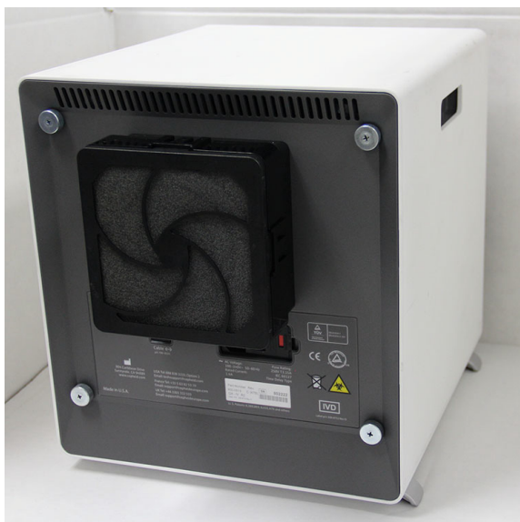
Figura 9-24. Instrument GX-IV poziționat pentru accesarea filtrului
