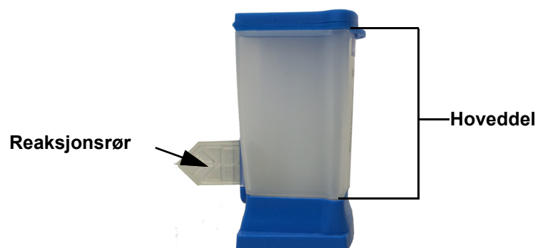
Figur 5-31. Patron som viser hoveddel og reaksjonsrør
