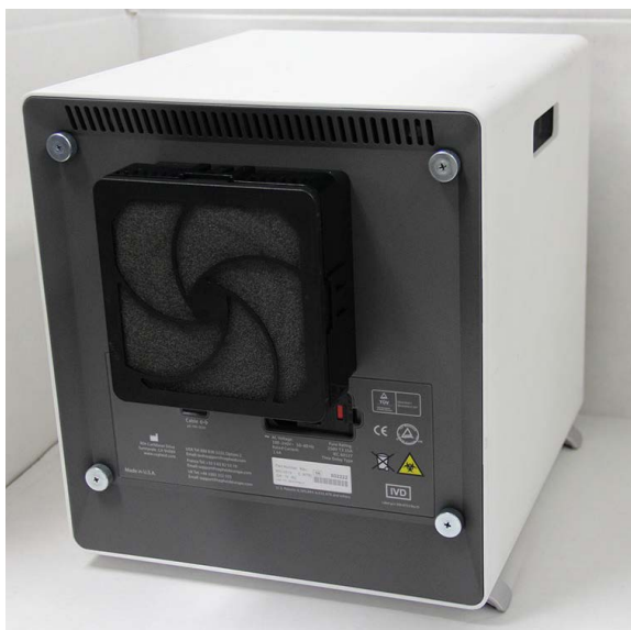
Afbeelding 9-24. GX-IV-instrument in positie voor toegang tot filter
