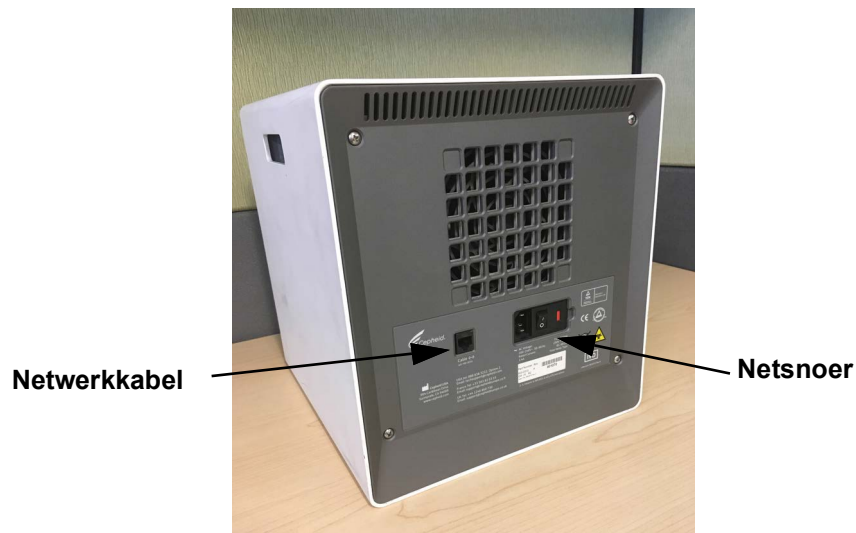
Afbeelding 9-13. Locaties netwerkkabel en netsnoer op oudere GX-IV
