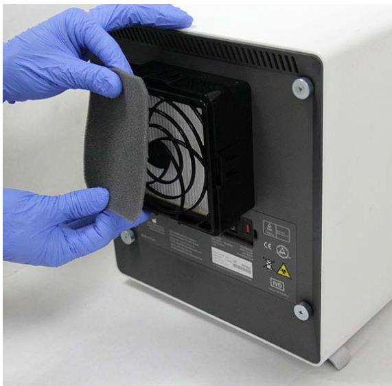
Afbeelding 9-26. Het voorfilter verwijderen
