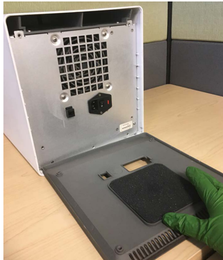
Afbeelding 9-16. Schuimfilter weer aanbrengen in oudere GX-IV
