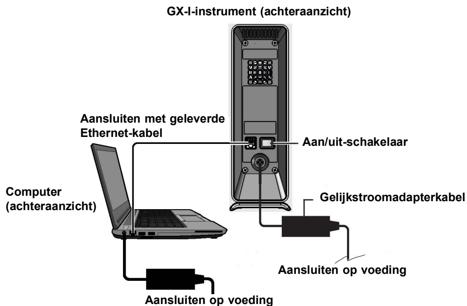
Afbeelding 2-5. Het GX-I-instrument aansluiten op de laptopcomputer
