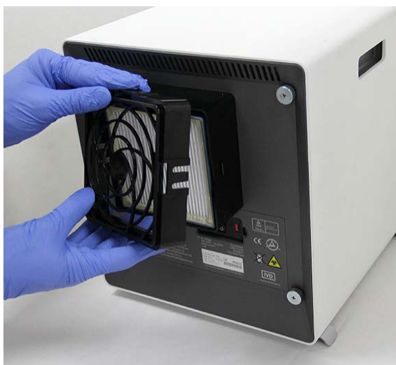
Afbeelding 9-27. De HE-filterhouder verwijderen
