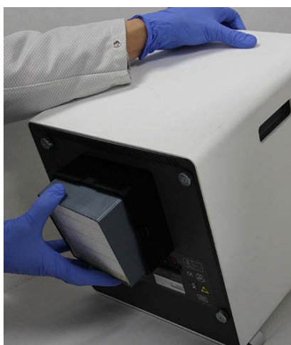
Afbeelding 9-28. Het HE-filter verwijderen
