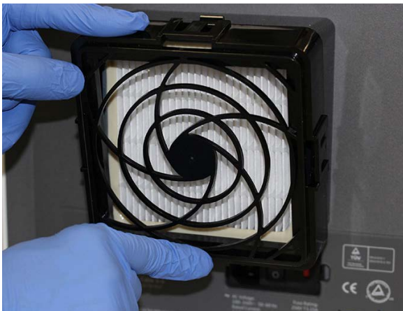
Afbeelding 9-30. De HE-filterhouder weer aanbrengen
