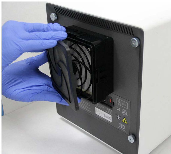
Afbeelding 9-25. De voorfilterhouder verwijderen
