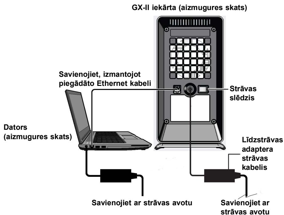
2-6. attēls. GX-II iekārtas savienošana ar klēpj datoru
