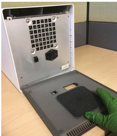
9-16. attēls. Putu filtra nomaiņa vecākā GX-IV modelī
