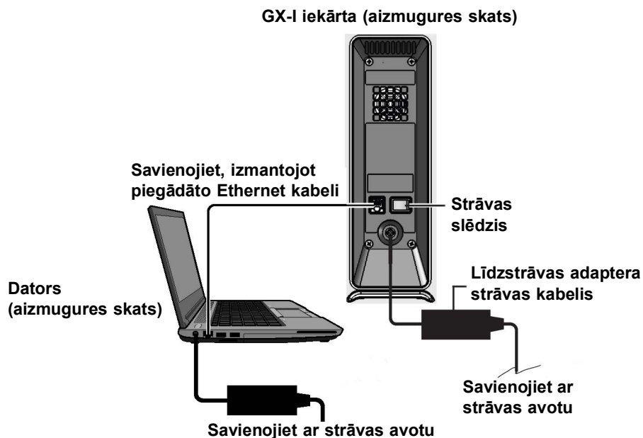
2-5. attēls. GX-I iekārtas savienošana ar klēpj datoru
