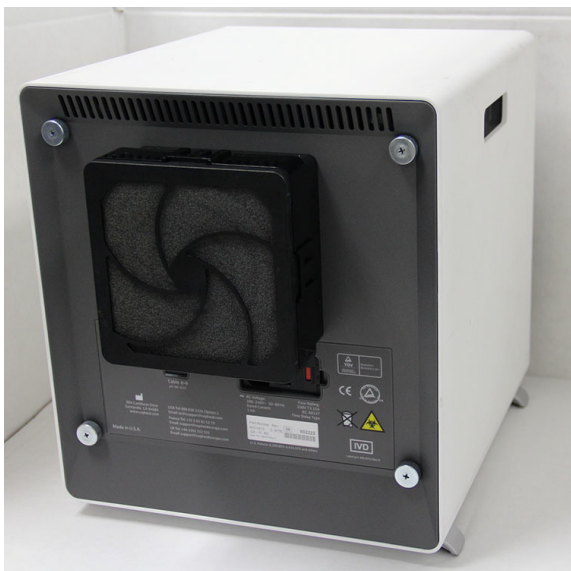
9-24 pav. „GX-IV“ prietaisas, pritaikytas prieigai prie filtro
