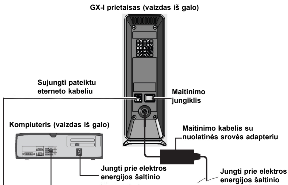
2-1 pav. GX-I prietaiso prijungimas prie stalinio kompiuterio
