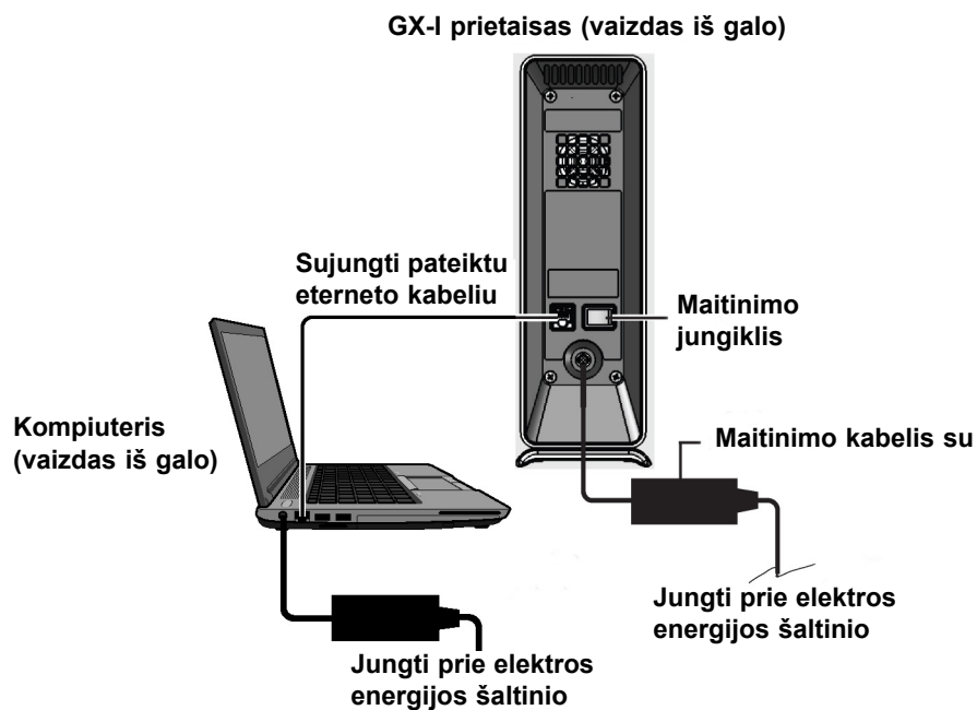
2-5 pav. GX-I prietaiso prijungimas prie nešiojamojo kompiuterio
