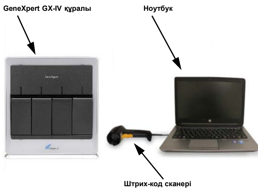
1-6-сурет. GeneXpert GX-IV аппараттық компоненттері (ноутбукпен бірге көрсетілген)
