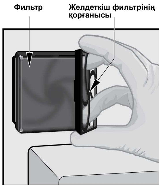
9-22-сурет. Желдеткіш фильтрінің қорғанысы мен фильтрді шешіп алу
