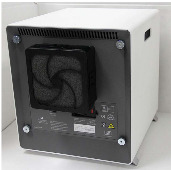
9-24-сурет. Фильтрге қол жететіндей етіп қойылған GX-IV құралы
