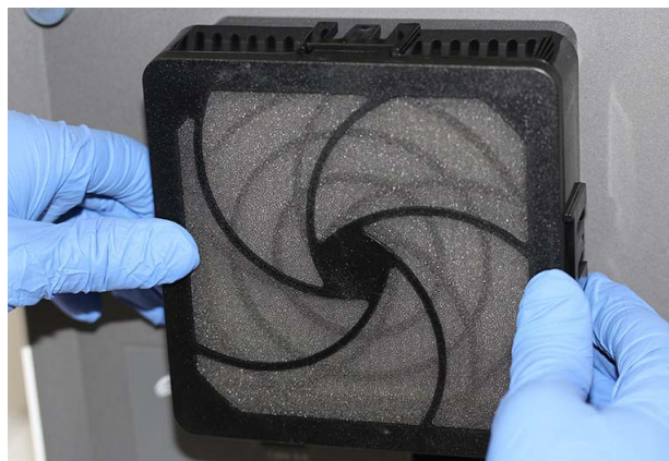
9-31-сурет. Префильтр мен префильтр ұстағышын орнына салу
