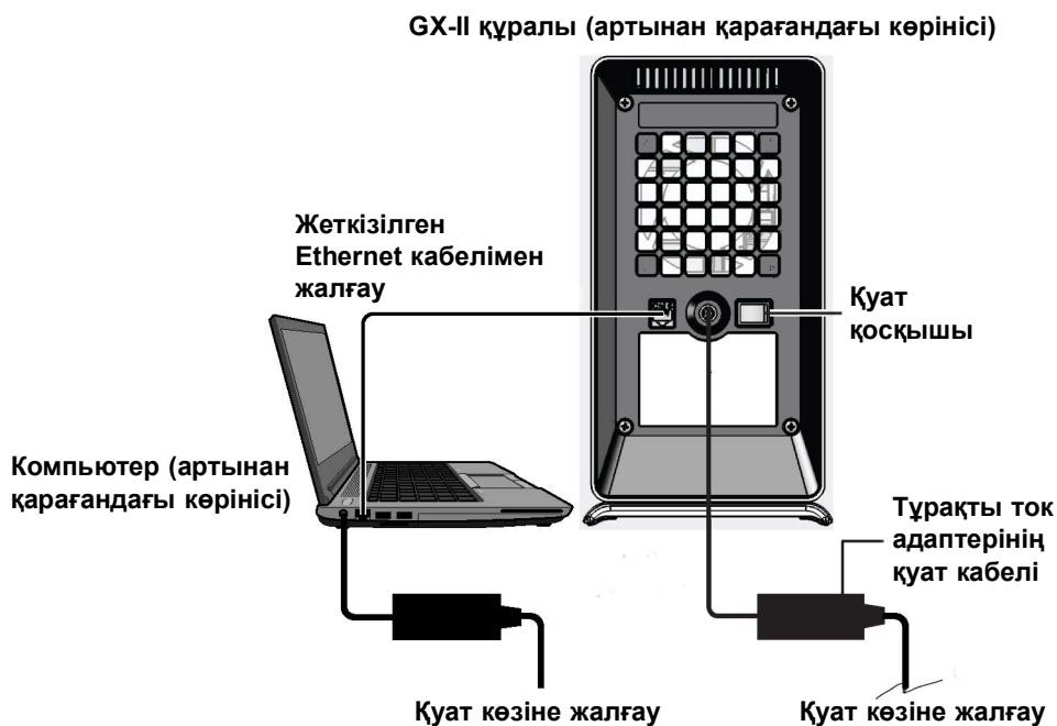
2-6-сурет. GX-II құралын ноутбукке жалғау
