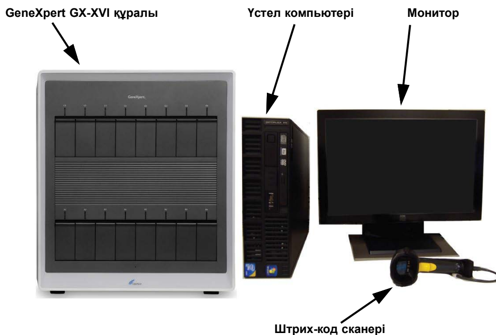
1-9-сурет. GeneXpert GX-XVI аппараттық компоненттері (үстел компьютерімен бірге көрсетілген)
