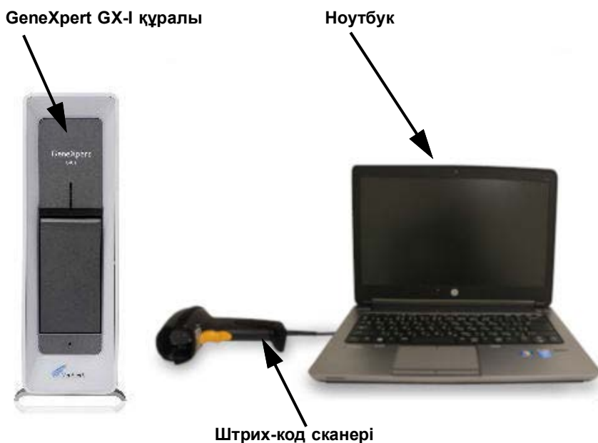
1-2-сурет. GeneXpert GX-I аппараттық компоненттері (ноутбукпен бірге көрсетілген)
