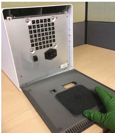
9-16-сурет. Ескі GX-IV құрылғысындағы поролон фильтрді ауыстыру
