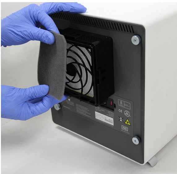
9-26. ábra Az előszűrő eltávolítása
