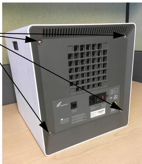
9-14. ábra Hátlap csavarjai a régebbi GX-IV-en
