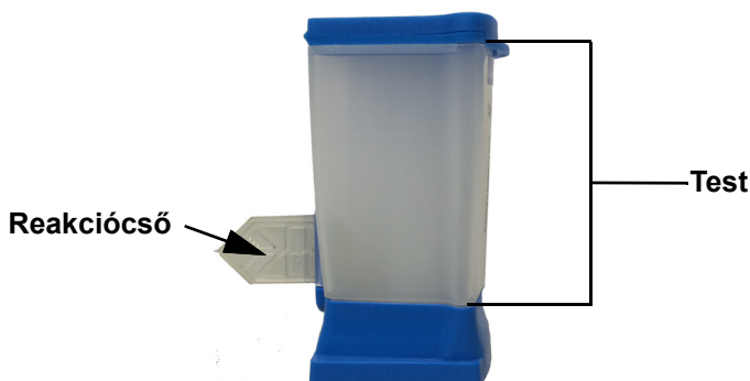
5-31. ábra A kazetta testét és reakciócsőjét bemutató ábra
