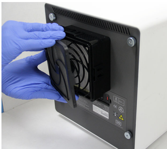
9-25. ábra Az előszűrő rögzítőelemének eltávolítása
