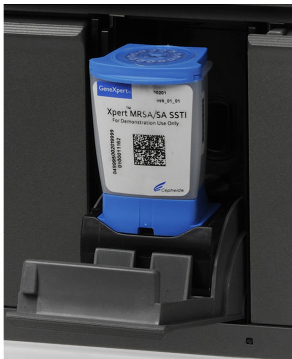
Kuva 5-33. GeneXpert-kasetti, sijoitettu moduuliosaston alustan kantaan
