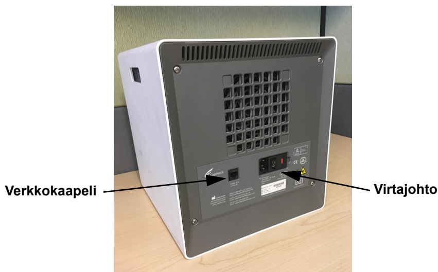
Kuva 9-13. Verkkokaapelin ja virtajohtojen sijainnit vanhemmissa GX-IV-malleissa
