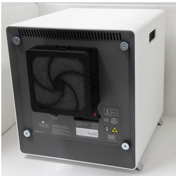
Kuva 9-24. GX-IV-instrumentti sijoitettu siten, että suodattimeen pääsee käsiksi
