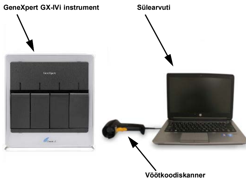
Joonis 1-6. GeneXpert GX-IV riistvara komponendid (näidatud koos sülearvutiga)
