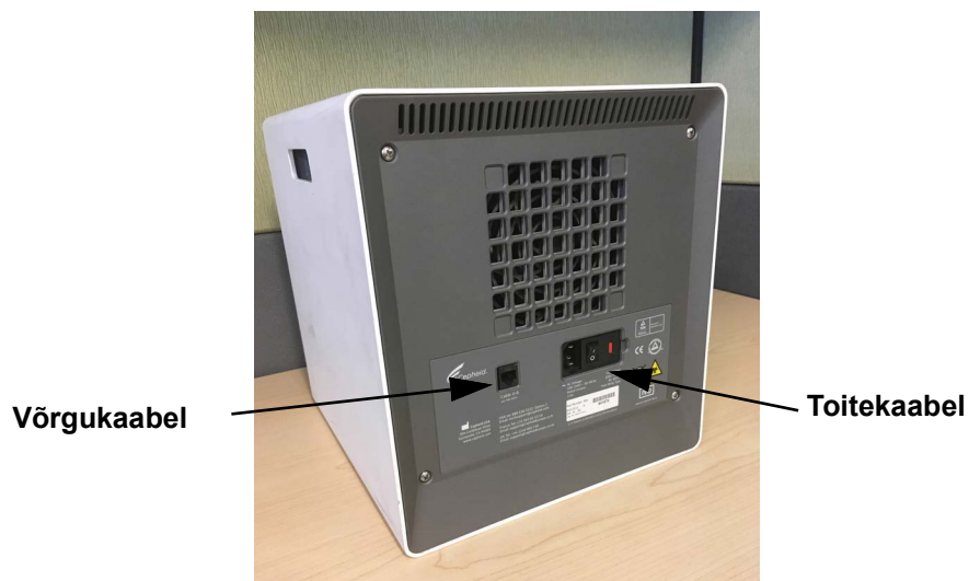
Joonis 9-13. Võrgukaabel ja toitekaabli asukohad vanemas GX-IV-s
