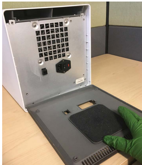
Joonis 9-16. Vahtfiltri vahetamine vanemas GX-IV-s
