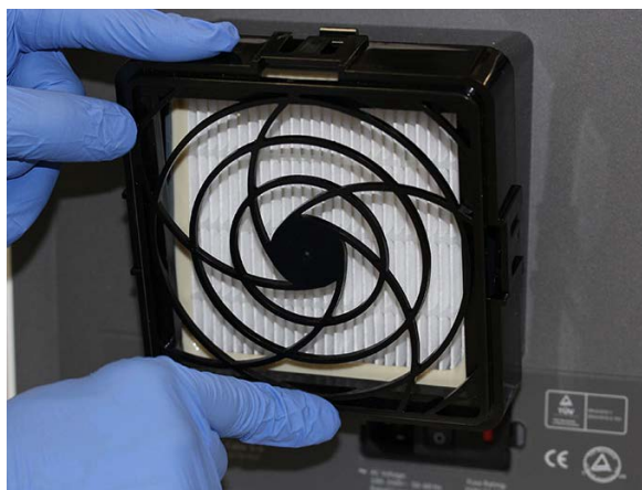
Joonis 9-30. HE-filtri kinnituse tagasi paigaldamine
