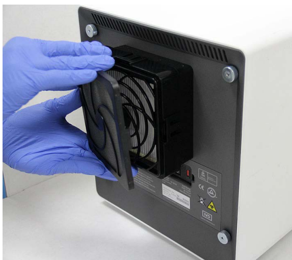
Joonis 9-25. Eemaldage eelfiltri kinnitus
