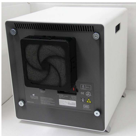
Joonis 9-24. Instrument GX-IV filtritele ligipääsu võimaldavas asendis
