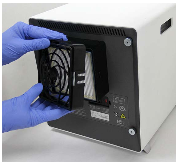
Joonis 9-27. HE-filtri kinnituse eemaldamine
