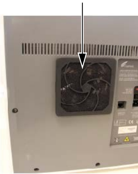
Joonis 9-23. Filtri ja kaitsekatte tagasi paigaldamine
