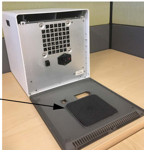
Joonis 9-15. Vahtfilter vanemas GX-IV-s
