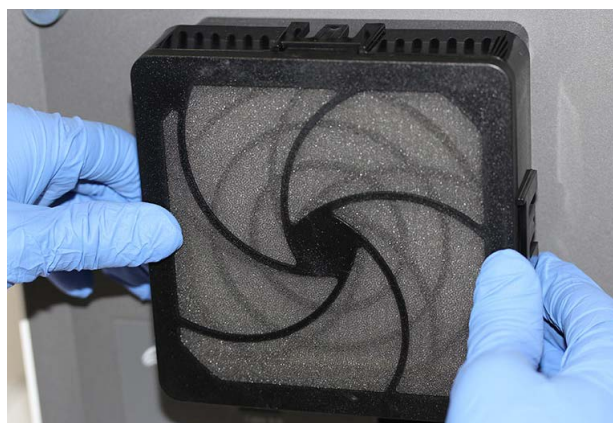
Joonis 9-31. Eelfiltri ja eelfiltri kinnituse tagasi paigaldamine
