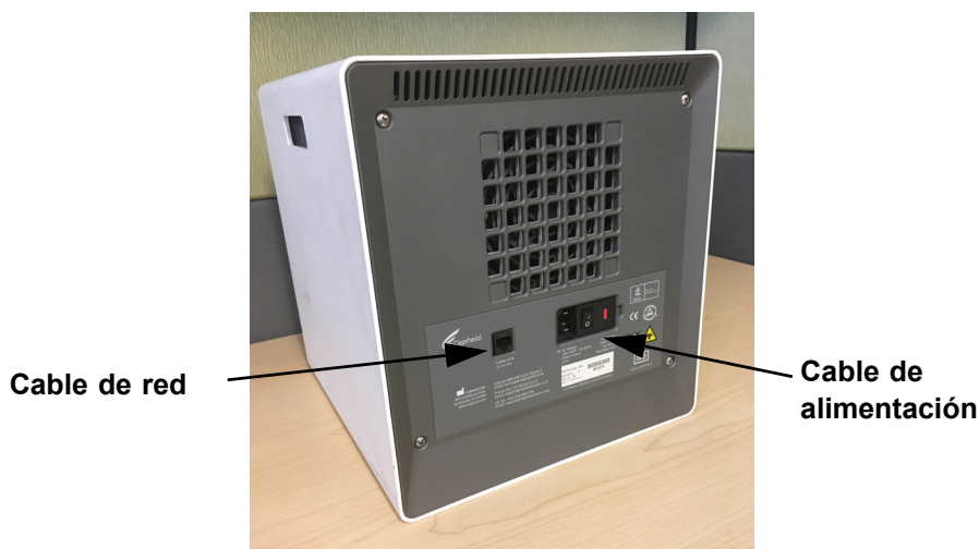
Figura 9-13. Ubicación del cable de red y el cable de alimentación en los modelos antiguos del GX-IV
