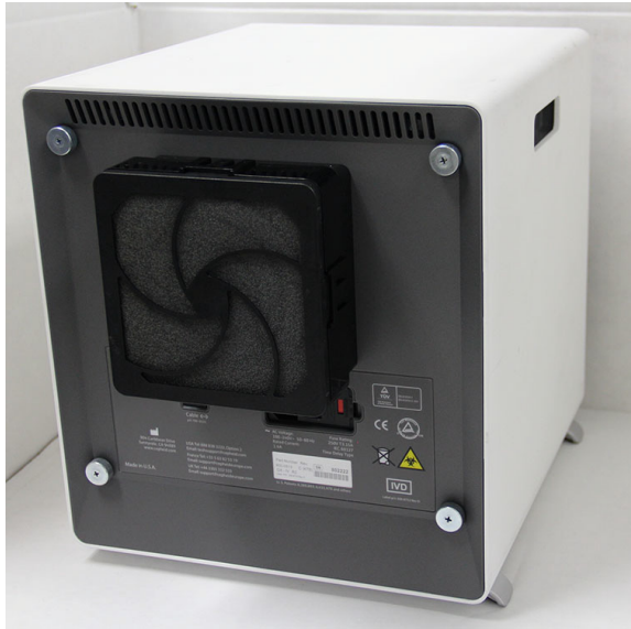
Figura 9-24. Instrumento GX-IV colocado para acceder al filtro
