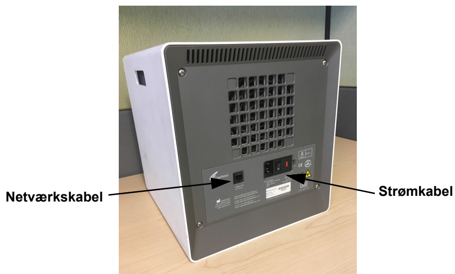
Figur 9-13. Netværkskabel- og strømkabelplaceringer på ældre GX-IV
