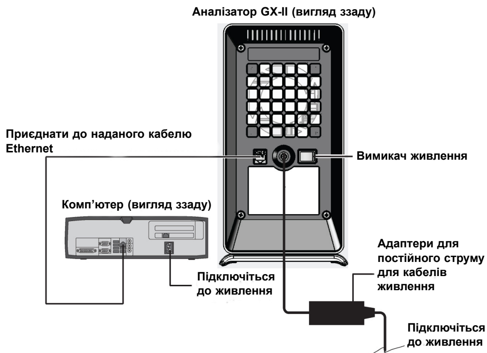
Малюнок 2-2. Підключення аналізатору GX-II до настільного комп'ютера
