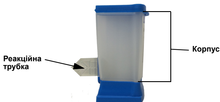
Малюнок 5-31. Зображення корпусу картриджа та реакційної трубки
