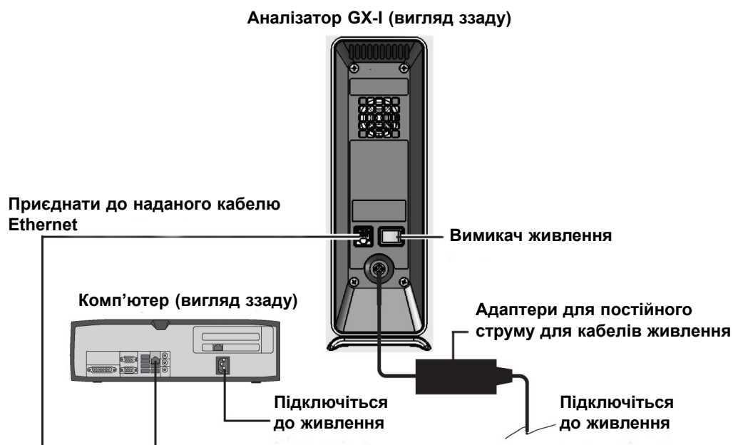
Малюнок 2-1. Підключення аналізатору GX-I до настільного комп'ютера
