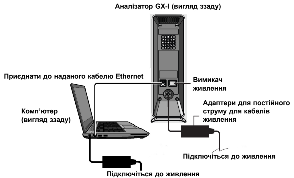
Малюнок 2-5. Підключення аналізатору GX-I до переносного комп'ютера
