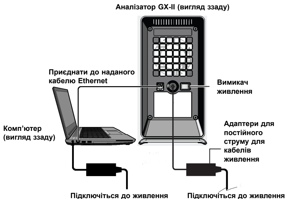
Малюнок 2-6. Підключення аналізатору GX-II до переносного комп'ютера
