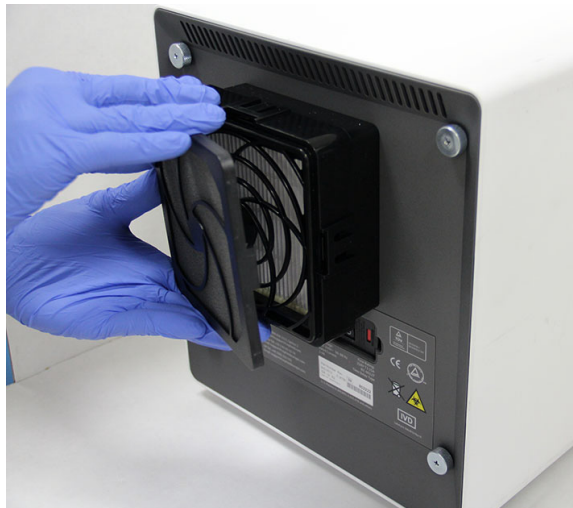
Figur 9-25. Borttagning av förfiltrets hållare
