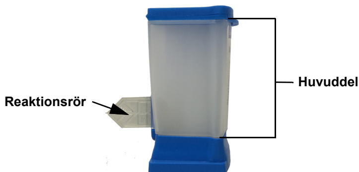
Figur 5-31. Kassett som visar huvuddel och reaktionsrör
