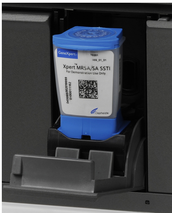
Figur 5-33. GeneXpert Kasset, placerad vid slutet av botten på modulnischen
