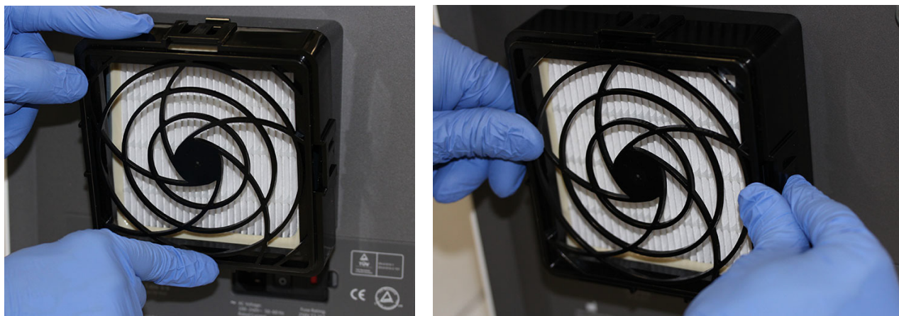
Figur 9-30. Ersättning av HE-filtrets hållare
