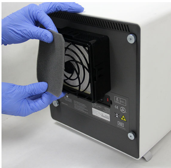
Figur 9-26. Borttagning av förfiltret
