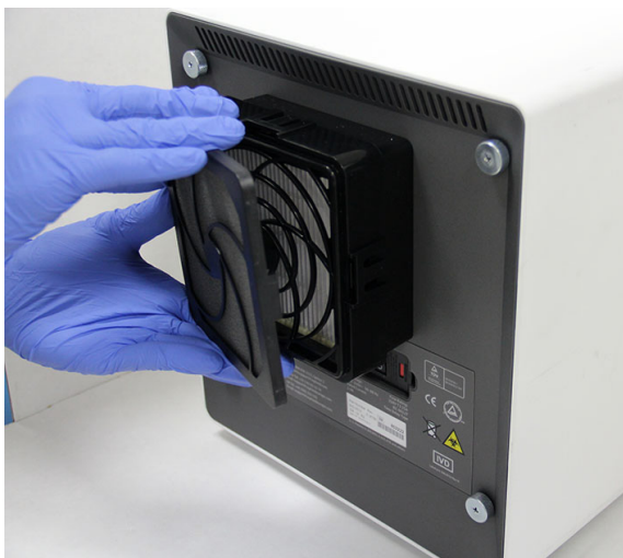
Figura 9-25. Scoaterea dispozitivului de fixare a prefiltrului
