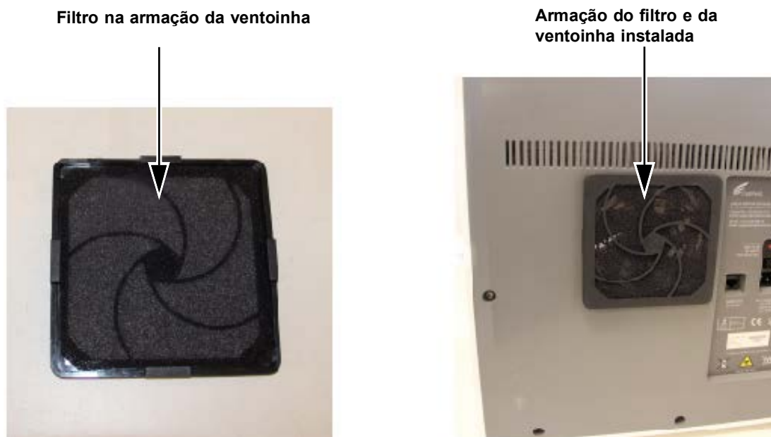
Figura 9-23. Substituir o filtro e a armação
