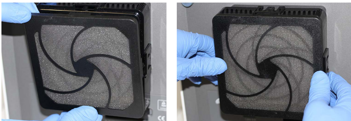
Figura 9-31. Substituição do pré-filtro e do retentor do pré-filtro
