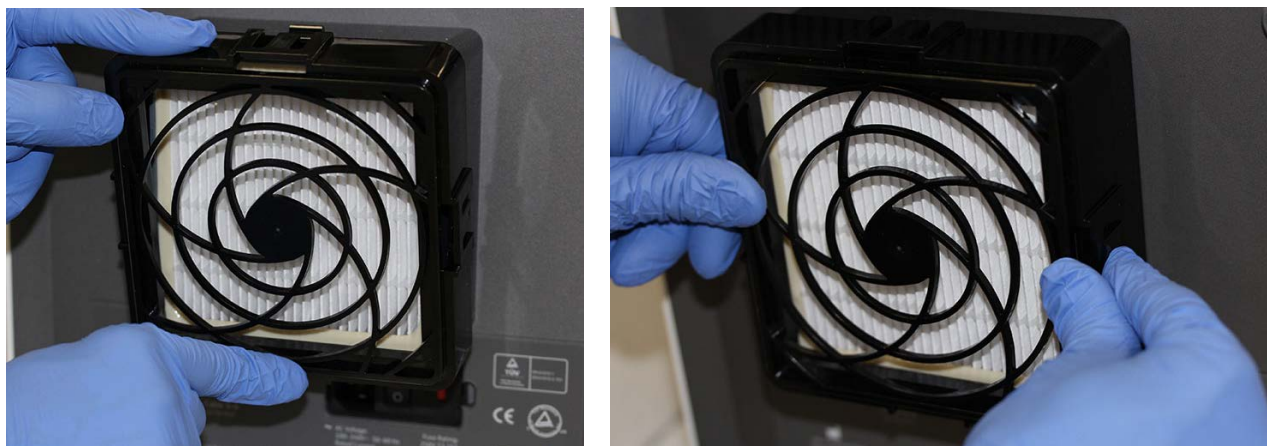
Figura 9-30. Substituição do retentor do filtro HE
