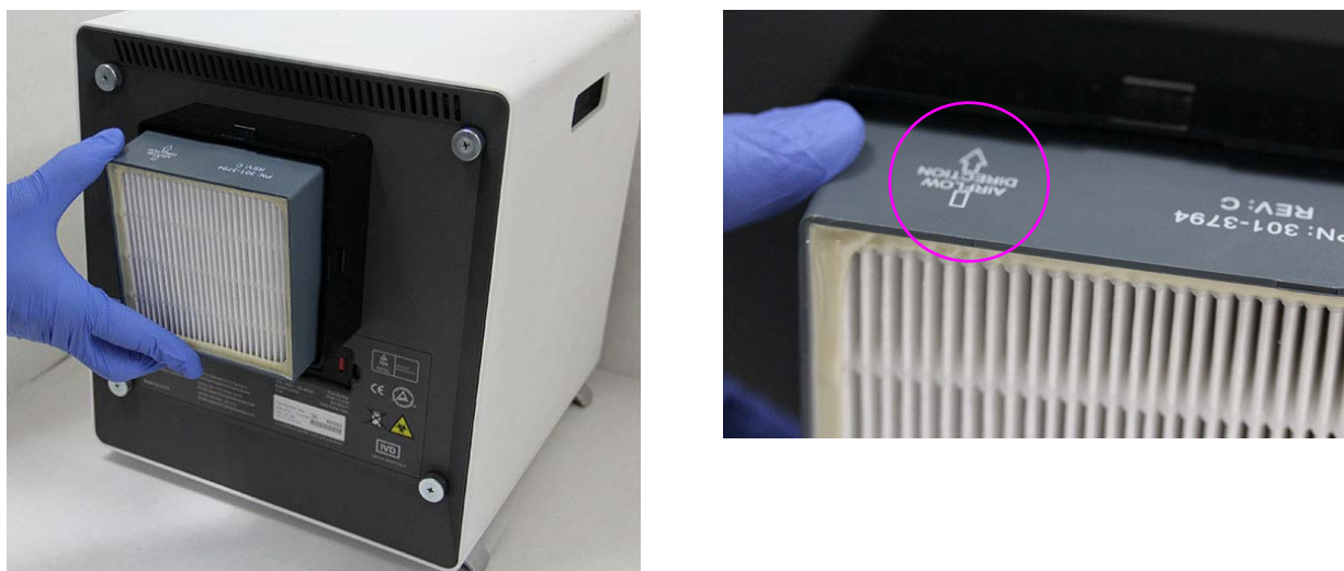
Figura 9-29. Substituição do filtro HE
