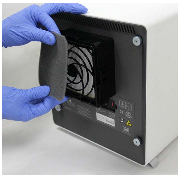
Figura 9-26. Remoção do pré-filtro
