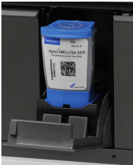
Figura 5-33. Cartucho GeneXpert, posicionado junto do calço da parte inferior do compartimento do módulo
