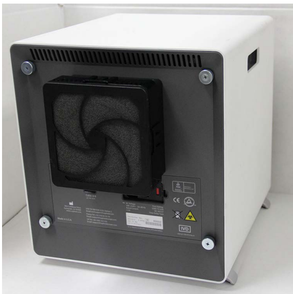
Figura 9-24. Instrumento GX-IV posicionado para acesso ao filtro
