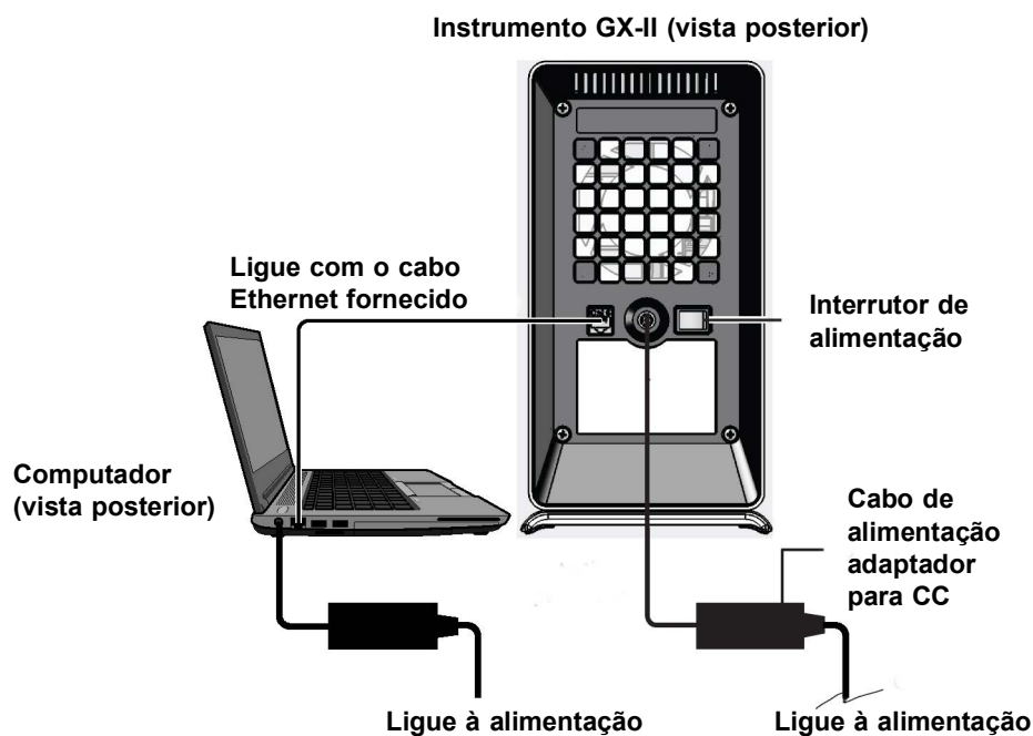
Figure 2-6. Ligar o instrumento GX-II ao computador portátil
