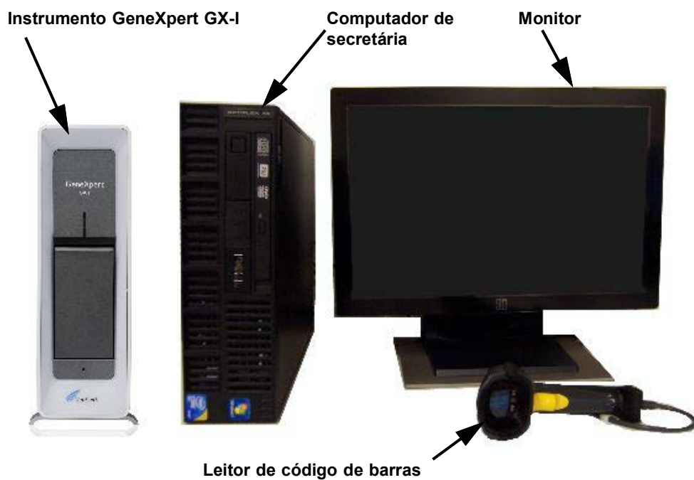
Figura 1-3. Componentes do hardware do GeneXpert GX-I (mostrado com o computador desktop)
