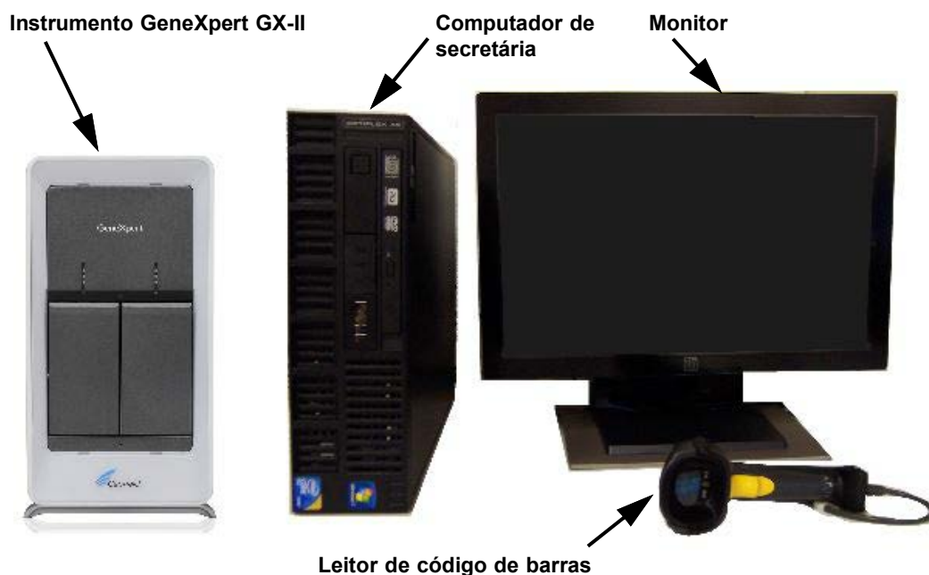
Figura 1-5. Componentes do hardware do GeneXpert GX-II (mostrado com o computador desktop)
