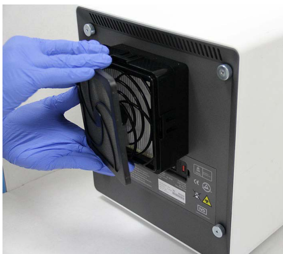
Figura 9-25. Remover o retentor do pré-filtro
