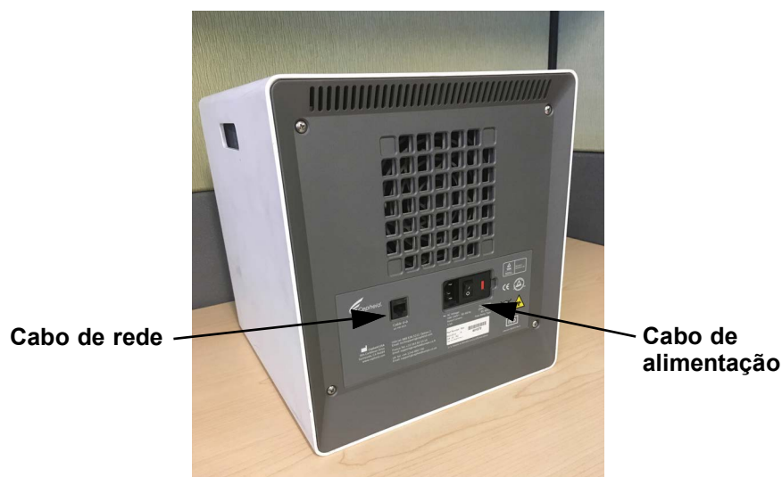
Figura 9-13. Cabo de rede e cabo de alimentação locais num GX-IV mais antigo
