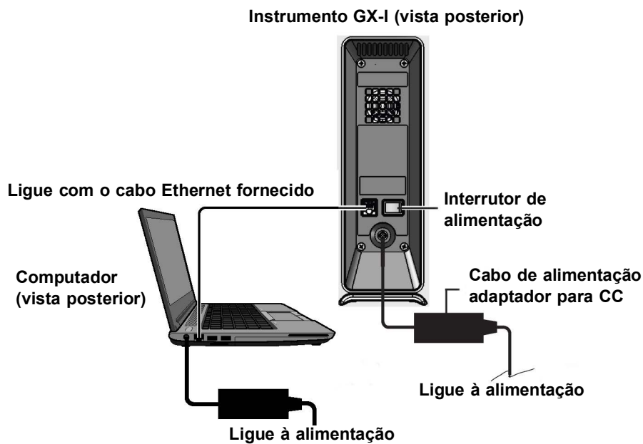
Figure 2-5. Ligar o instrumento GX-I ao computador portátil
