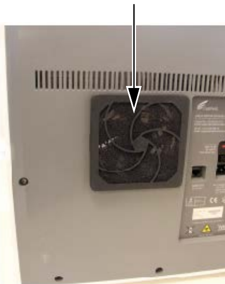
Ilustracja 9-23. Wymiana filtra i osłony
