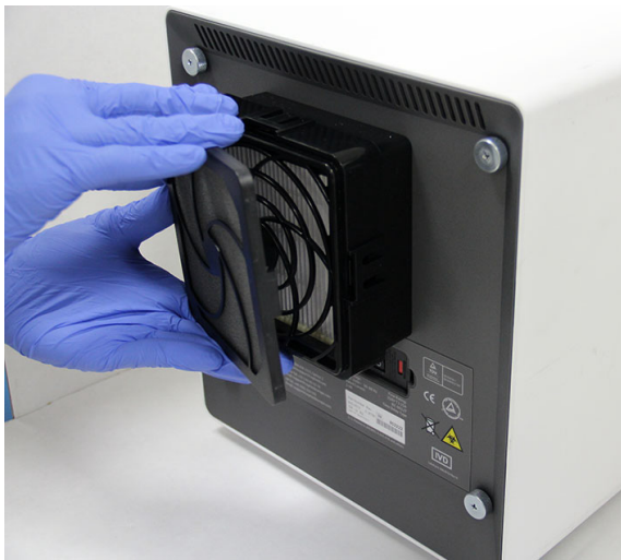
Afbeelding 9-25. De voorfilterhouder verwijderen
