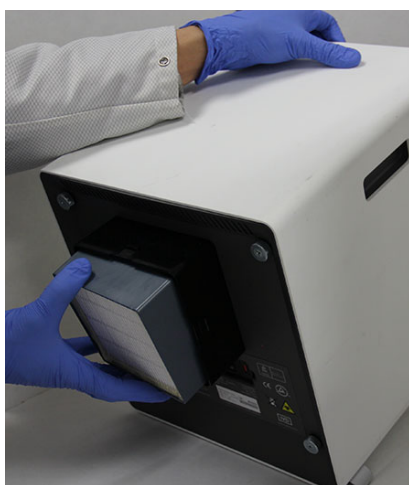
Afbeelding 9-28. Het HE-filter verwijderen
