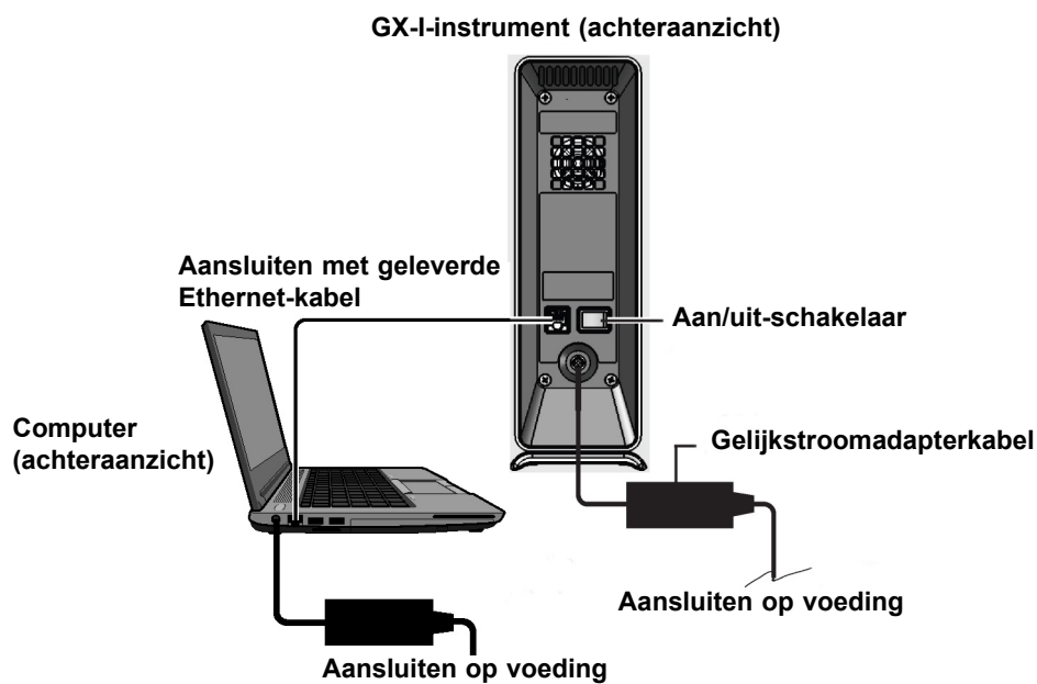
Afbeelding 2-5. Het GX-I-instrument aansluiten op de laptopcomputer
