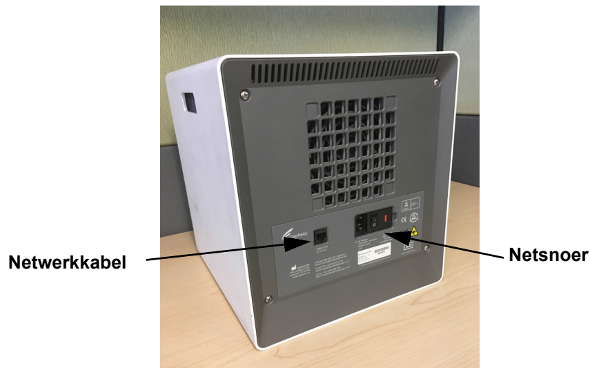
Afbeelding 9-13. Locaties netwerkkabel en netsnoer op oudere GX-IV
