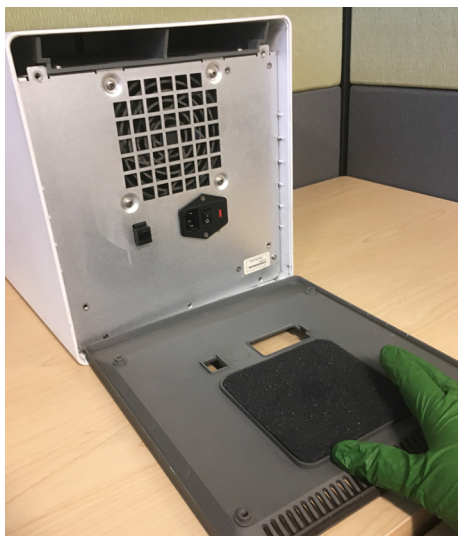
Afbeelding 9-16. Schuimfilter weer aanbrengen in oudere GX-IV
