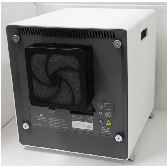
Afbeelding 9-24. GX-IV-instrument in positie voor toegang tot filter
