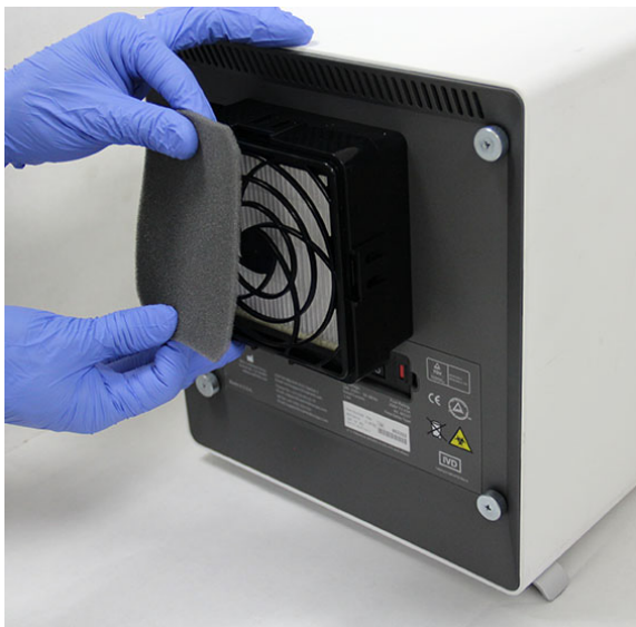
Afbeelding 9-26. Het voorfilter verwijderen
