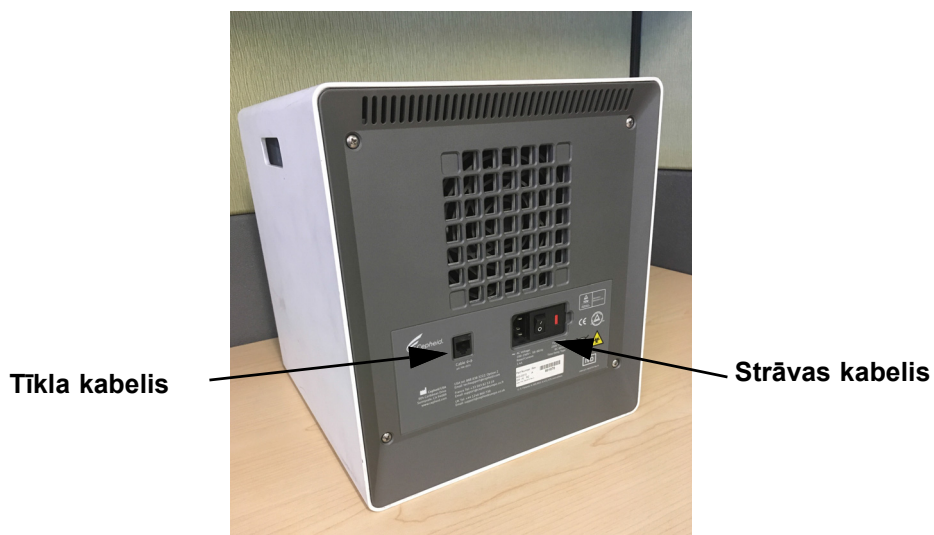
9-13. attēls. Tīkla kabeļa un strāvas kabeļa pieslēgvietu atrašanās vietas vecākā GX-IV modelī
