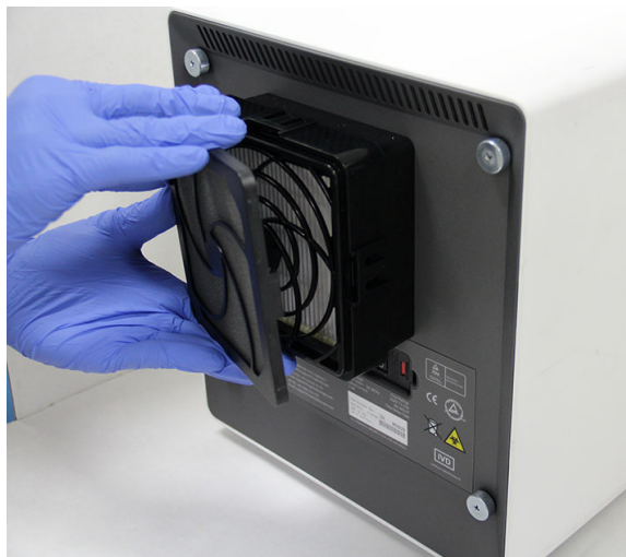
9-25. attēls. Priekšfiltra aiztura noņemšana
