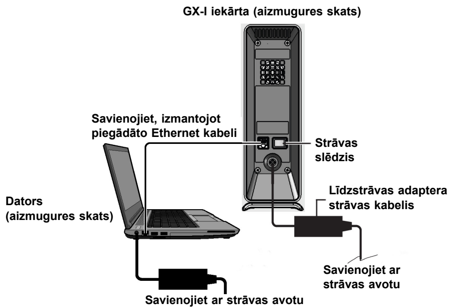
2-5. attēls. GX-I iekārtas savienošana ar klēpj datoru
