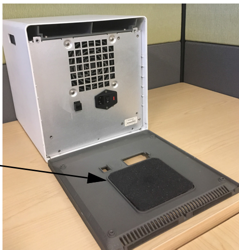
9-15. attēls. Putu filtrs vecākā GX-IV modelī
