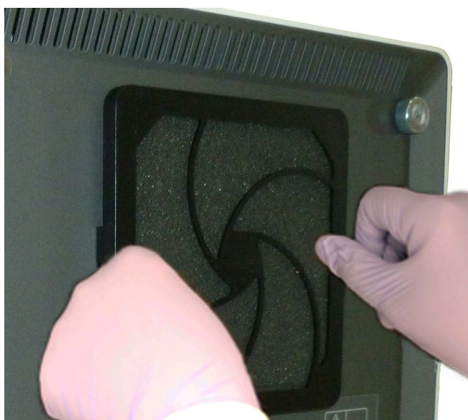
GX-IV: бүйірлерін орнына басып кіргізу
