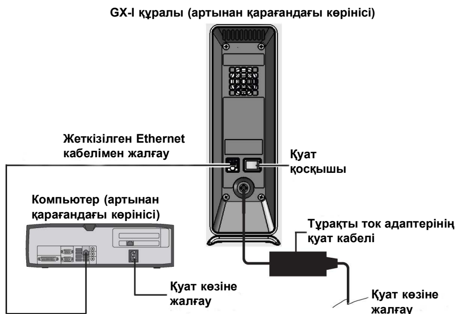
2-1-сурет. GX-I құралын үстел компьютеріне жалғау
