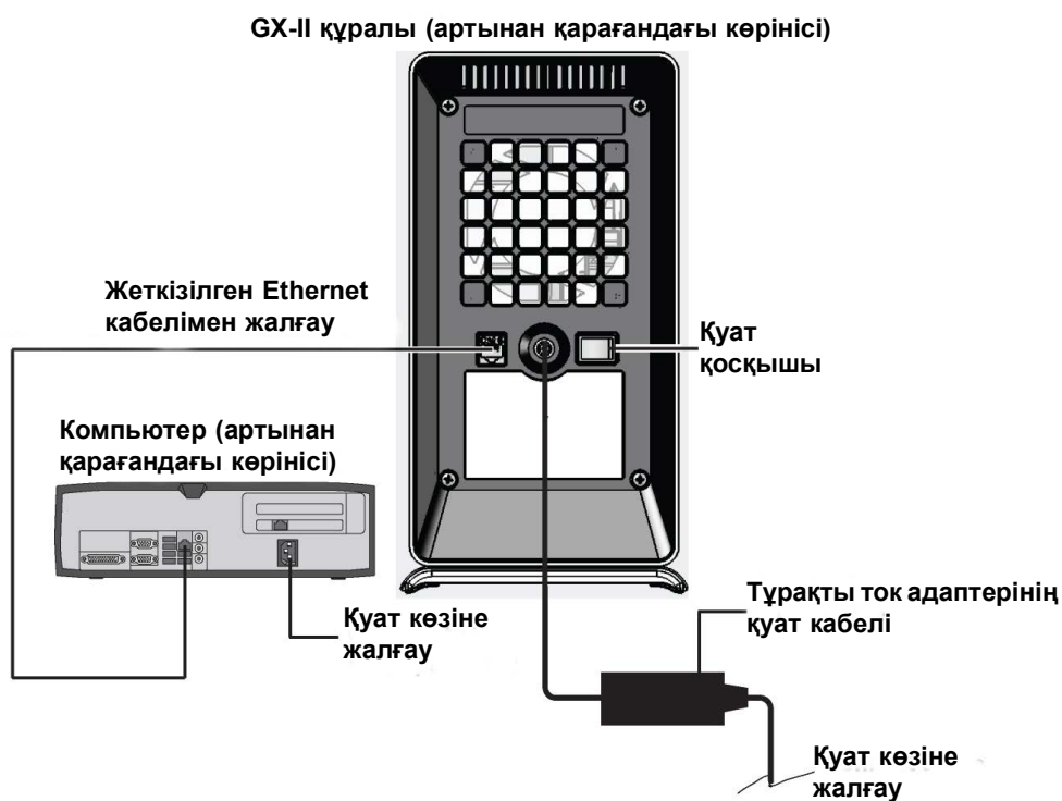
2-2-сурет. GX-II құралын үстел компьютеріне жалғау
