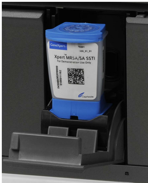
5-33-сурет. Модуль бөлімінің өкшесіне орналастырылған GeneXpert картриджі
