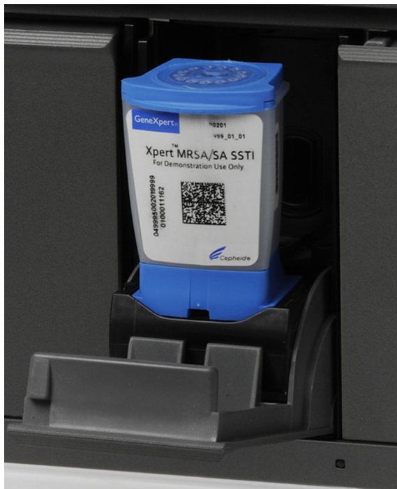
Figura 5-33. Cartuccia GeneXpert posizionata all'estremità del fondo dell'alloggiamento del modulo
