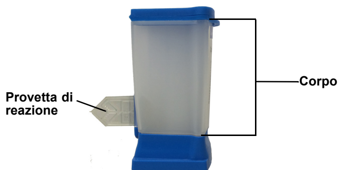
Figura 5-31. Cartuccia con corpo e provetta di reazione
