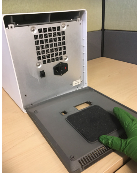
Kuva 9-16. Vaahtomuovisuodattimen vaihto vanhemmissa GX-IV-malleissa
