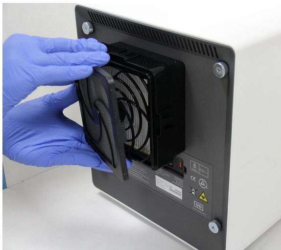
Kuva 9-25. Esisuodattimen pidikkeen irrotus
