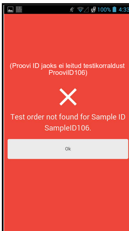
Joonis 5-104. Cepheid Linki skanneri vea kuva (korraldust ei leitud – punane X)
