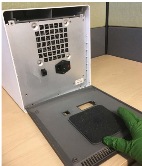
Joonis 9-16. Vahtfiltri vahetamine vanemas GX-IV-s
