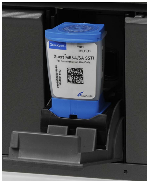
Joonis 5-33. GeneXperti kassett, mis on asetatud mooduli lahtri põrandale kanna juurde
