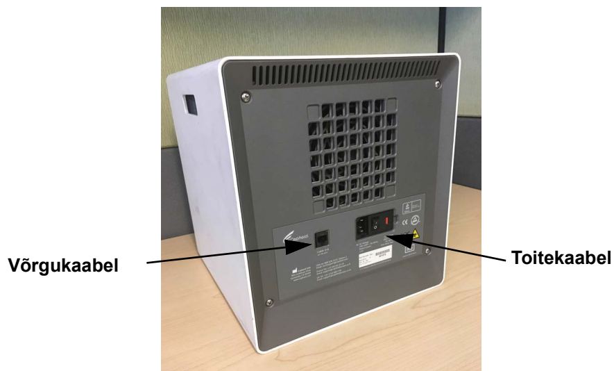
Joonis 9-13. Võrgukaabel ja toitekaabli asukohad vanemas GX-IV-s
