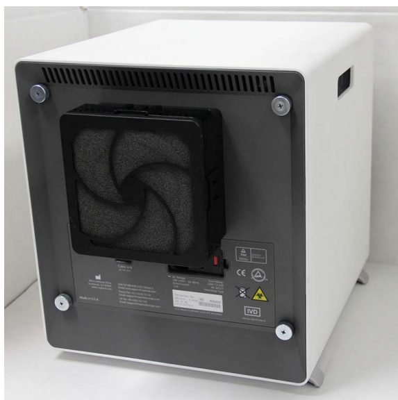
Joonis 9-24. Instrument GX-IV filtritele ligipääsu võimaldavas asendis
