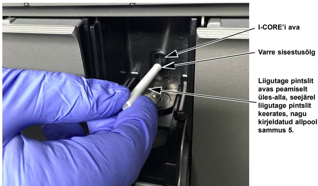
Joonis 9-7. Puhastuspintslit sisestamine I-CORE'i avasse
