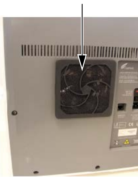
Joonis 9-23. Filtri ja kaitsekatte tagasi paigaldamine
