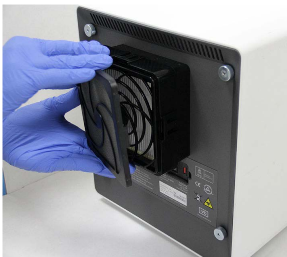
Joonis 9-25. Eemaldage eelfiltri kinnitus
