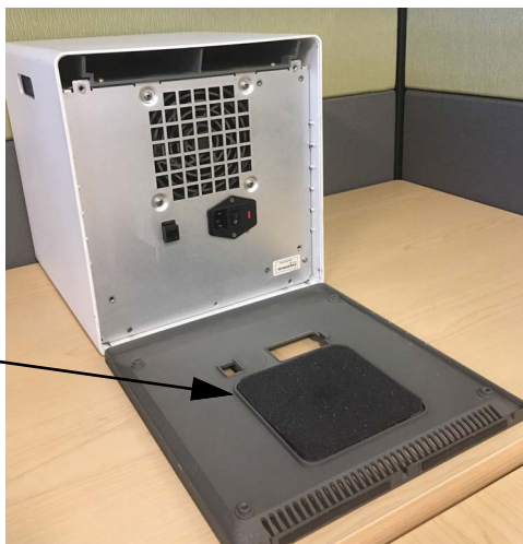
Joonis 9-15. Vahtfilter vanemas GX-IV-s
