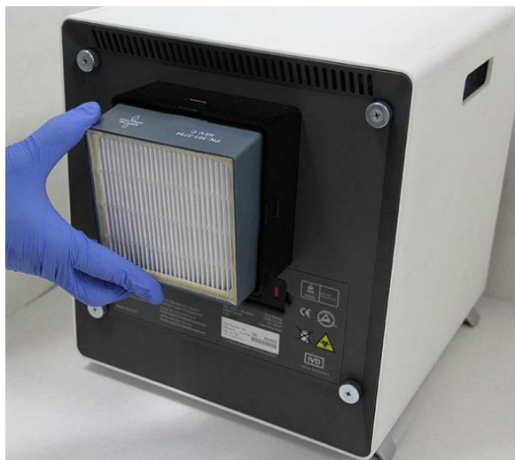
Joonis 9-29. HE-filtri vahetamine
