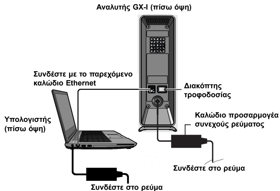
Εικόνα 2-5. Σύνδεση του αναλυτή GX-I σε φορητό υπολογιστή
