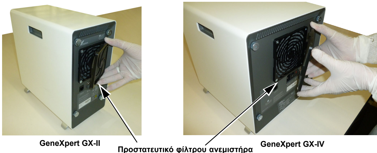
Εικόνα 9-9. Αφαίρεση του προστατευτικού του φίλτρου του ανεμιστήρα
