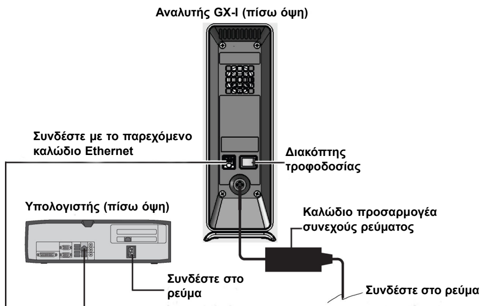
Εικόνα 2-1. Σύνδεση του αναλυτή GX-I σε σταθερό υπολογιστή
