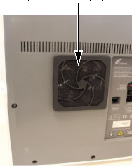
Εικόνα 9-23. Αντικατάσταση του φίλτρου και του προστατευτικού
