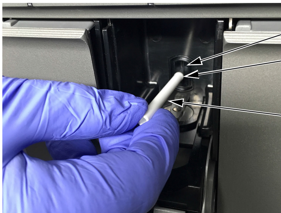
Εικόνα 9-7. Εισαγωγή βούρτσας καθαρισμού στη σχισμή του I-CORE
