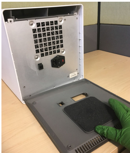
Εικόνα 9-16. Επανατοποθέτηση φίλτρου αφρώδους υλικού σε παλαιότερο GX-IV
