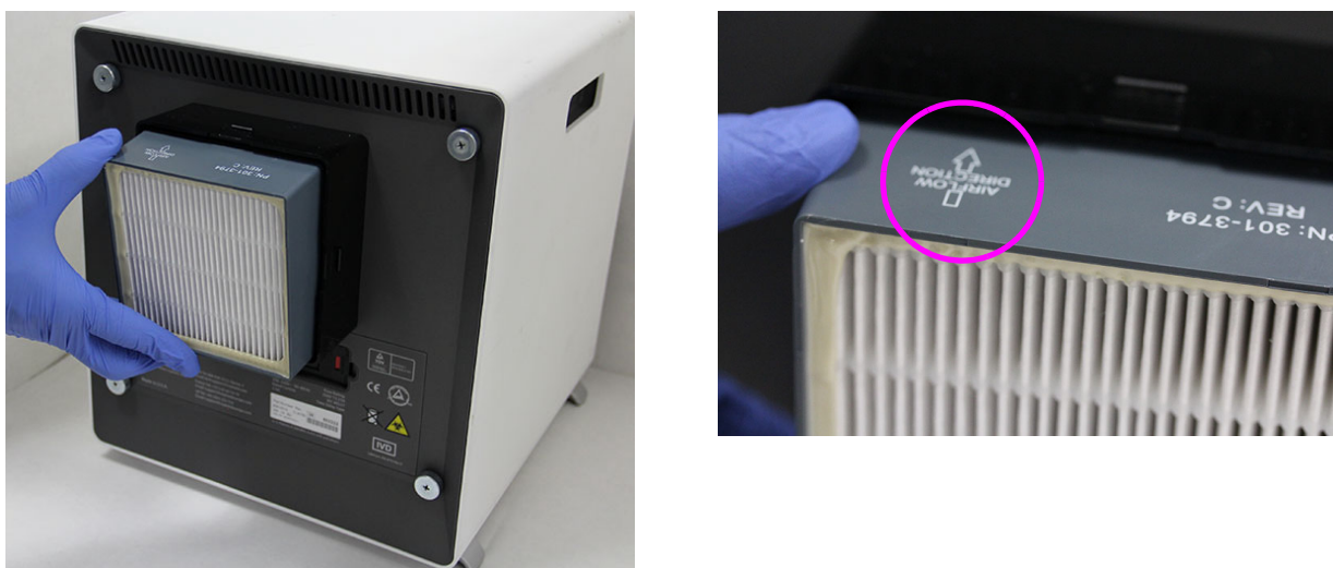
Εικόνα 9-29. Αντικατάσταση του φίλτρου HE
