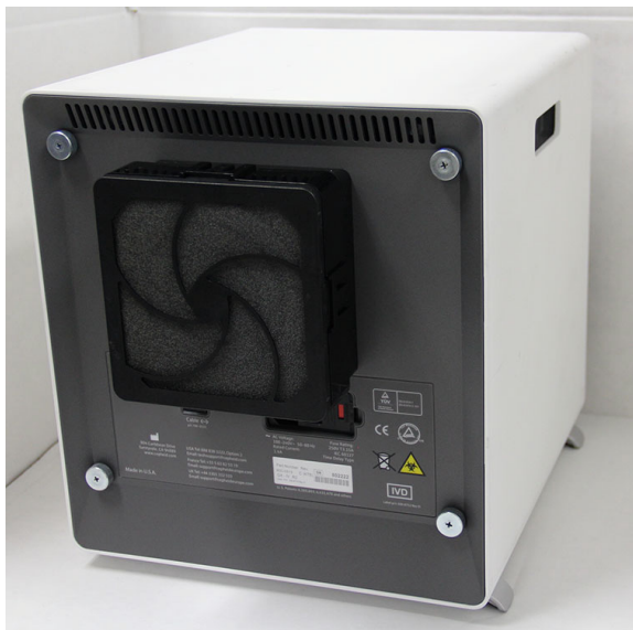
Εικόνα 9-24. Αναλυτής GX-IV τοποθετημένος για πρόσβαση στο φίλτρο
