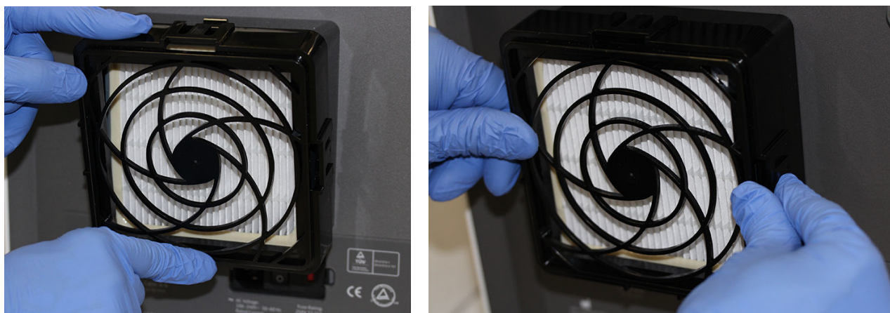
Εικόνα 9-30. Αντικατάσταση του συγκρατητήρα φίλτρου HE
