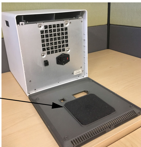
Εικόνα 9-15. Φίλτρο αφρώδους υλικού σε παλαιότερο GX-IV
