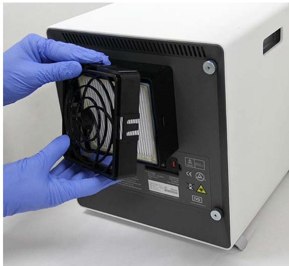
Abbildung 9-27. Abnehmen der HE-Filter-Halterung
