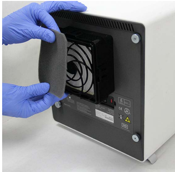
Abbildung 9-26. Entnehmen des Vorfilters
