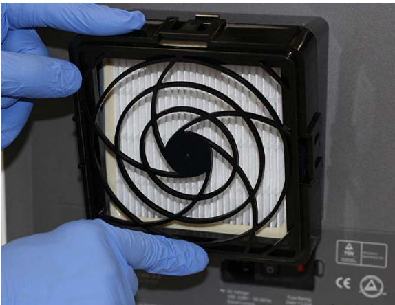
Abbildung 9-30. Wiederanbringen der HE-Filterhalterung
