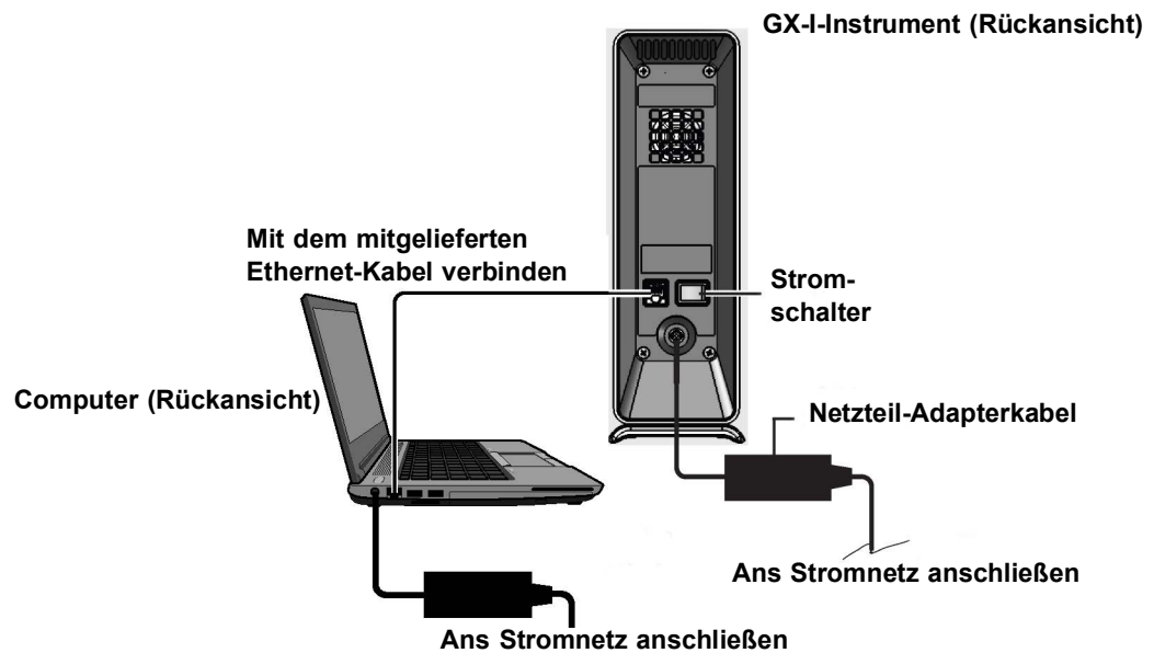
Abbildung 2-5. Anschließen des GX-I-Instruments an den Laptop-Computer
