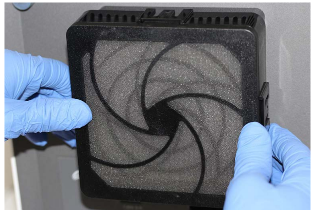
Abbildung 9-31. Wiederanbringen des Vorfilters und der Vorfilterhalterung
