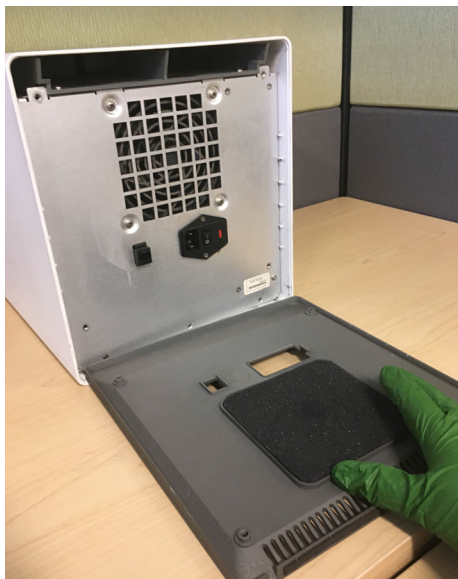
Figur 9-16. Udskiftning af skumfilter i ældre GX-IV
