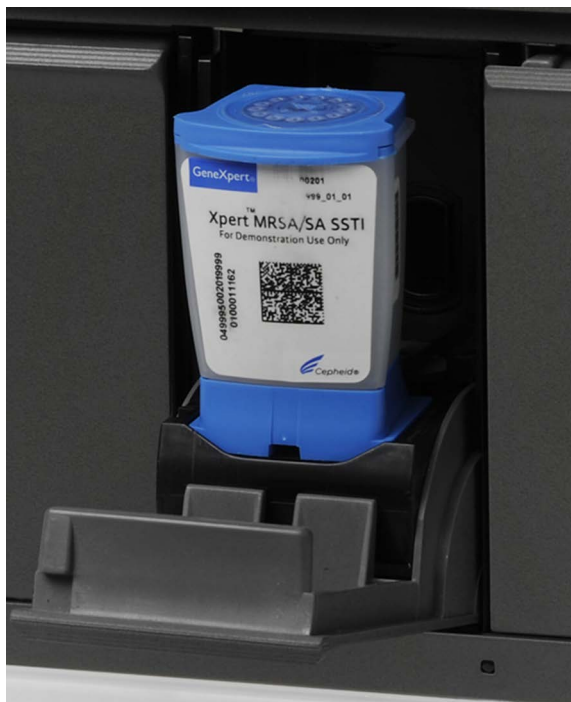
図 6-33. モジュールベイフロアの前端に配置された GeneXpert 試薬カートリッジ
