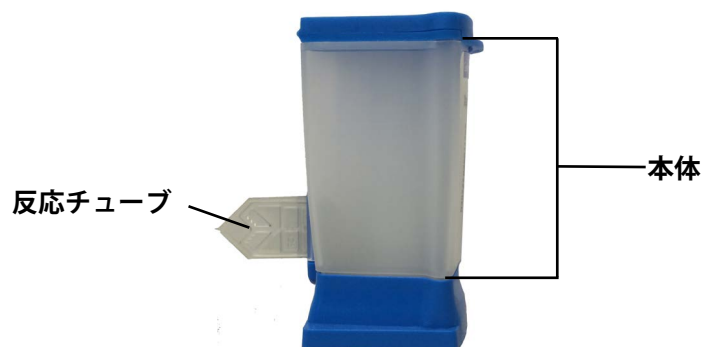
図 6-31. 試薬カートリッジの本体および反応チューブ
