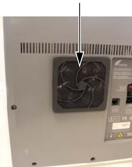
図 9-14. ファンフィルターとファンフィルターガードの交換
