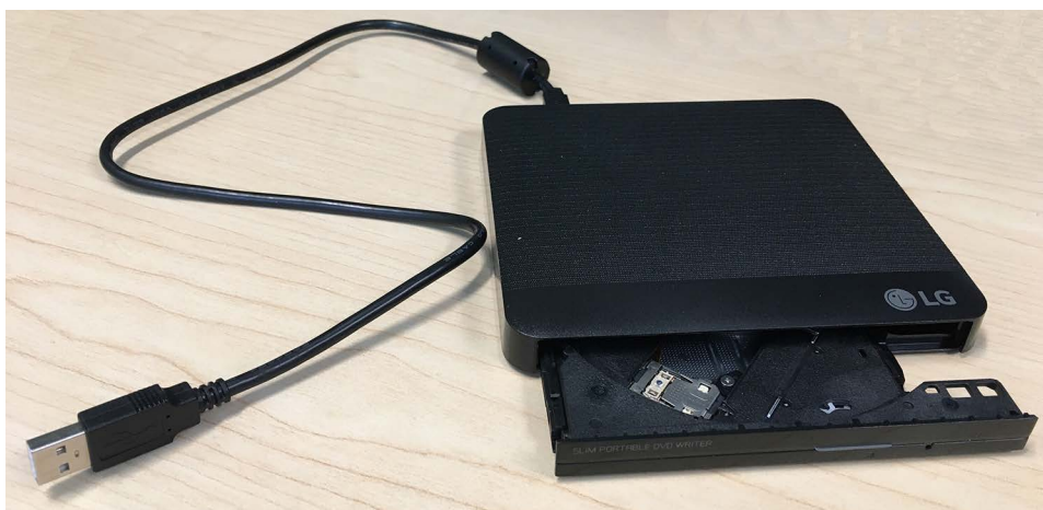
Hình 6. Ổ đĩa DVD được cung cấp, được minh họa với Cửa nạp đang mở
