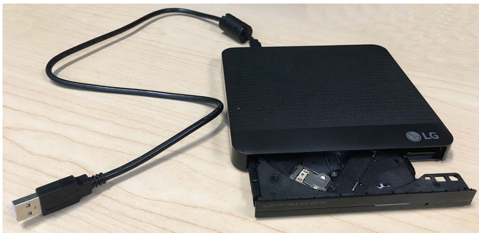
Ilustracja 6. Dostarczony napęd DVD, przedstawiony z wysuniętą tacką ładunkową
